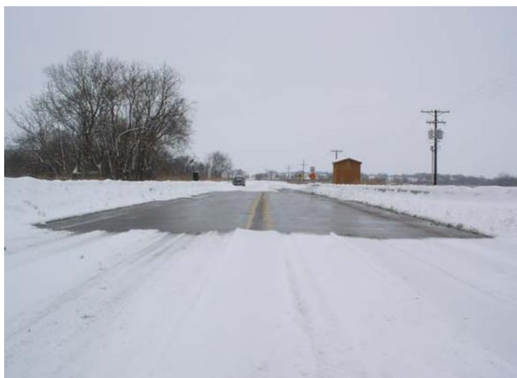
Figura 2.2: Prueba piloto de pavimento conductor con efecto deshielo (Yehia and Tua, 2000)
