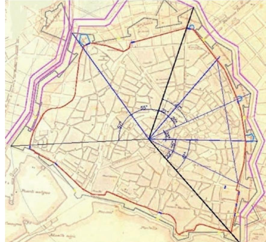
Plano 8. REPRESENTACIÓN DE LOS ESQUEMAS GEOMÉTRICOS DE LOS FRENTEROS TERRESTRES. *Reglas geométricas en el trazado de la muralla del plano de 1897.* Elaboración propia.
