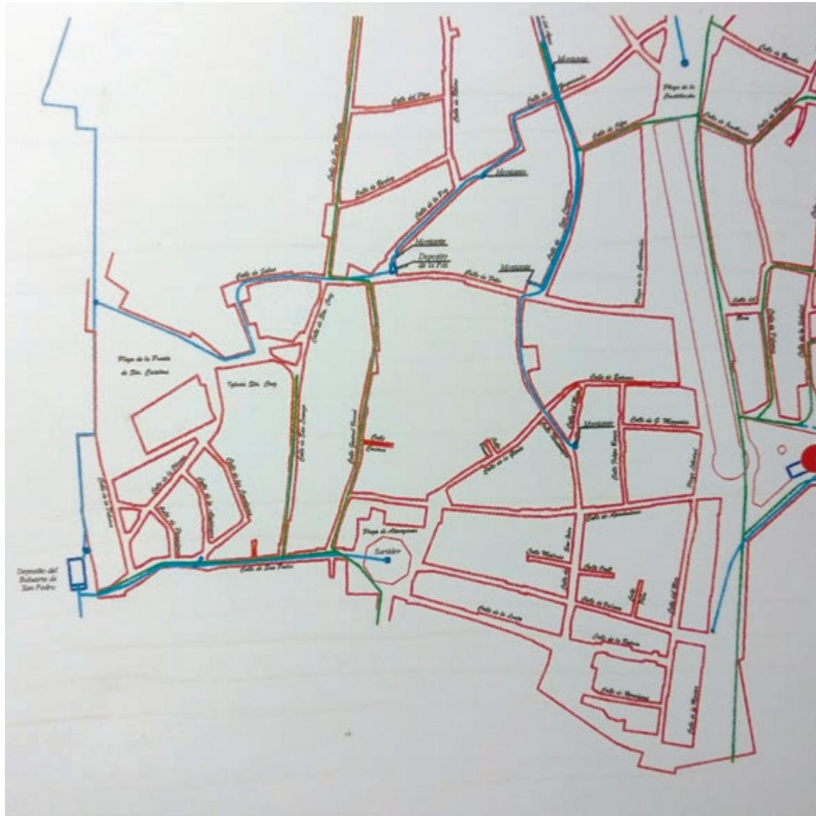
Figura 1. PLANO CANALIZACIÓN AGUA DE PALMA. Detalle del plano municipal donde figuran canalización de agua y alcantarillado así como los depósitos o aljibes públicos y los surtidores. Sin firmar, 1890. AMP. Pl 540.
