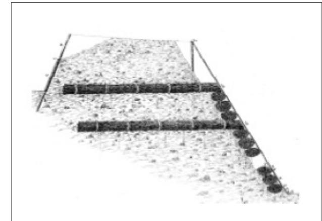
Figura 2. SECCIÓN TIPO DE UN MURO DE TIERRA Y FAJINA.
