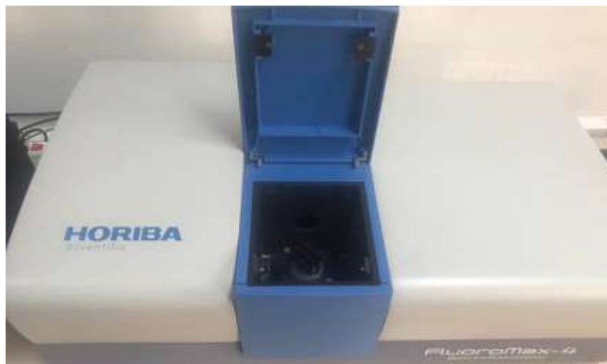
Figure 3.9. Image du dispositif Fluoromax 4 P Horiba .
