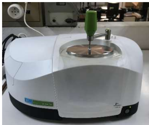
Figure 3.5. Spectromètre FT-IR de type PERKIN-ELMER-983 G utilisé dans cette thèse.
