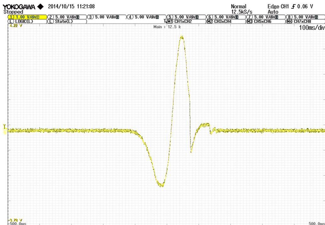
Figura 2.4. Oscilograma obtenido de la tensión de un solo transductor
