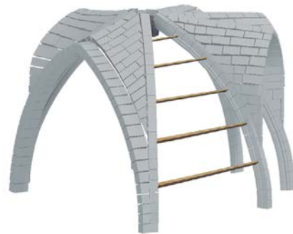
2. Maderos horizontales insertados en las entalladuras de los nervios, auxiliados por el andamio general o castillete
