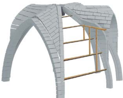
5. Apoyo de sillares en la estructura horizontal de maderos, auxiliados por el andamio general o castillete.
