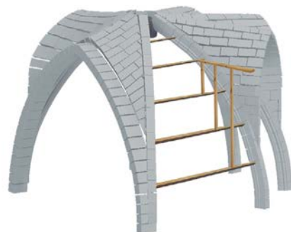
4. Colocación de los siguientes maderos horizontales, auxiliados por el andamio general o castillete
