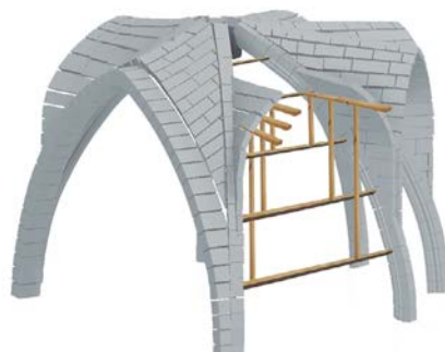
6. Multiplicación de maderos de apoyo para las siguientes hileras de sillares, auxiliado por el andamio general o castillete.
