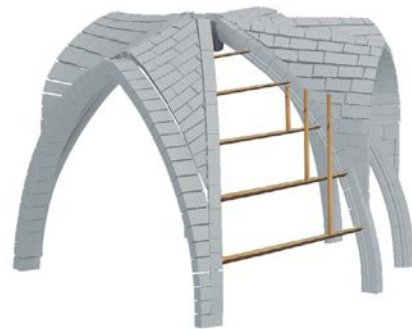
3. Colocación de cambios verticales, auxiliados por el andamio general o castillete.
