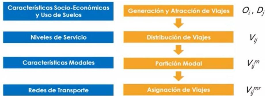
Figura 78. Modelo clásico de transporte de cuatro etapas. Fuente: www.uc.cl.
