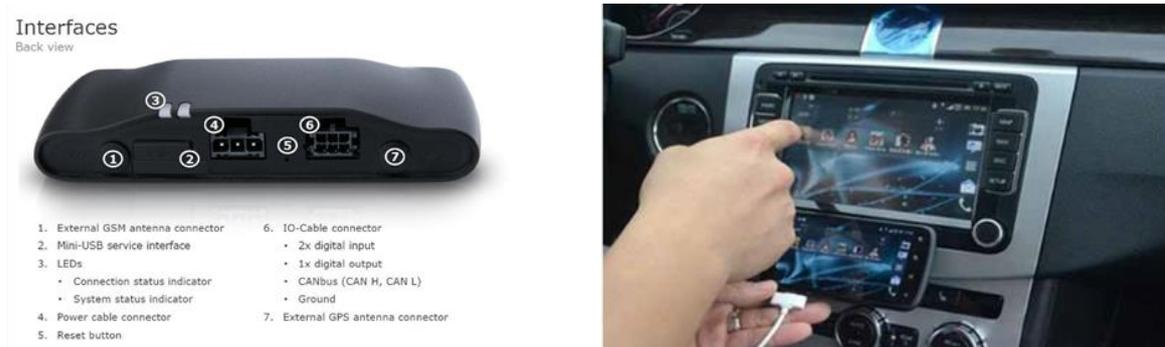
Figura 70. Ejemplo de equipo de abordo e integración en vehículo y “smartphone”. Fuente: TomTom Telematic.
