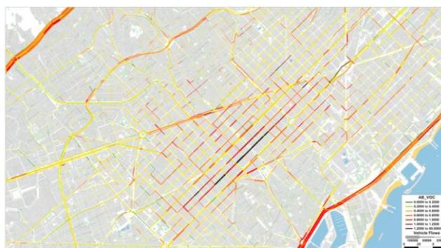
Figura 95. Diagrama de tráfico después de la aplicación del peaje 16 cts/km en la ciudad de Barcelona.
