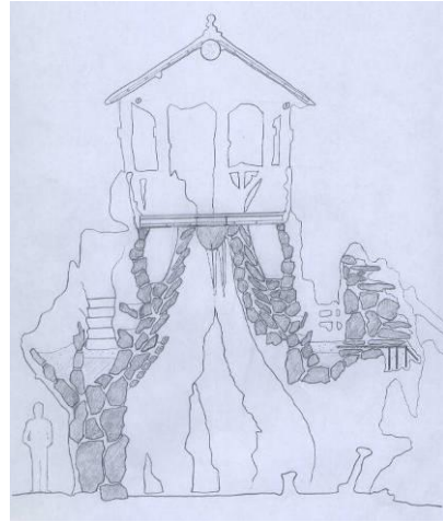
Fig. 152: Secció constructiva transversal de la Cova-cascada. Dibuix de David Agulló, arquitecte.
