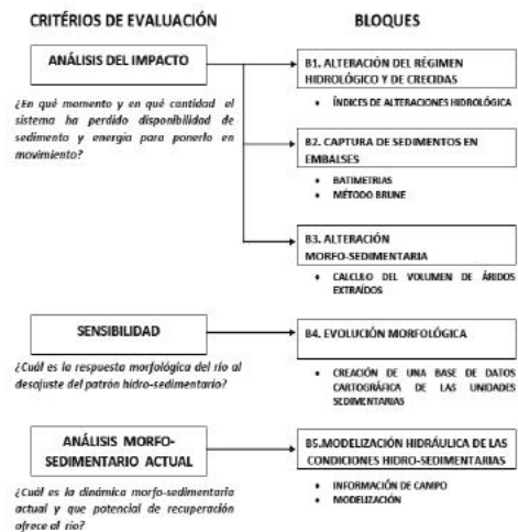
Fig. 2. Diagrama metodológico general empleado para el diagnóstico de la dinámica morfo-sedimentaria del tramo medio del río Segre.
