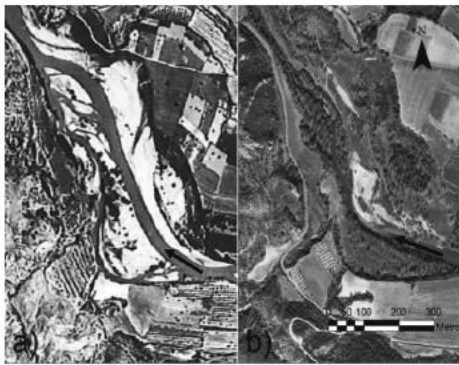
Fig. 1. Fotografías aéreas del río Segre en el paraje de Sant Julià, municipio de Alòs de Balaguer (32,5 km aguas debajo de la presa de Rialb). Entre la fotografía aérea del año a) 1956 y el ortofotomapa del año b) 2008 se observa una pérdida importante de áreas sedimentarias activas (i.e. barras) y una reducción de la superficie activa del cauce debido a la intrusión de la vegetación de ribera. La flecha indica la dirección del flujo.
