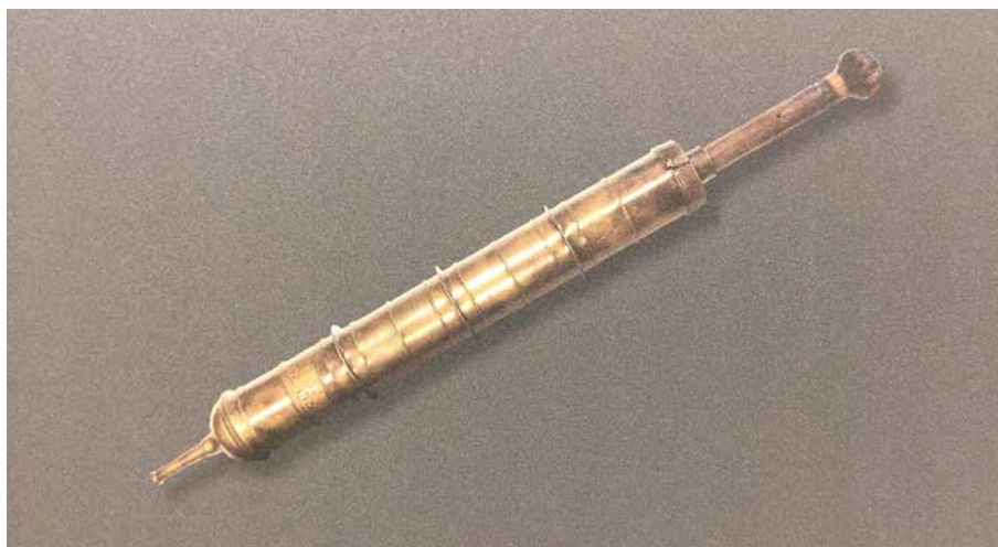
Fig. 2. Xeringa d'extinció d'incendis utilitzada en l'Edat Mitjana. Font: Espai Bombers. Parc de la Prevenció de Barcelona
