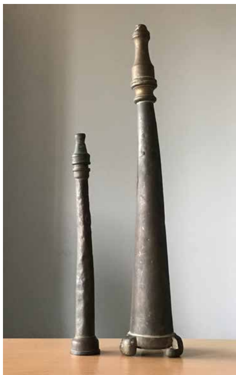
Fig 64. Fotografia d'una llança per a projectar aigua. Font: Fons del parc de bombers de Lleida. Imatge de l'autor
