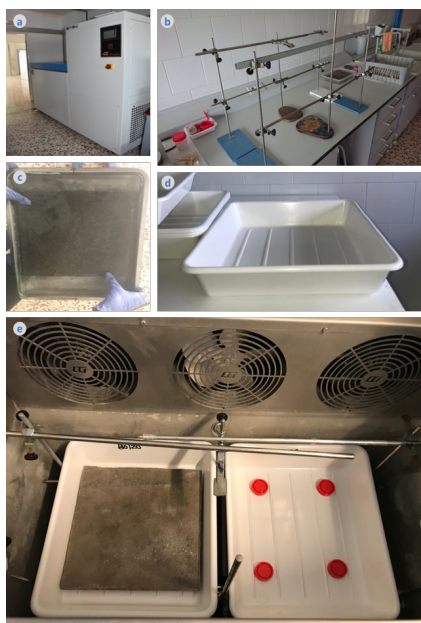
Figura III-18 Proceso del ensayo: (a) cámara climática (b) estructura para soporte de bandejas dentro de la cámara climática (c) probeta congelada (d) bandeja (e) montaje de probetas. Fuente: Elaboración propia.
