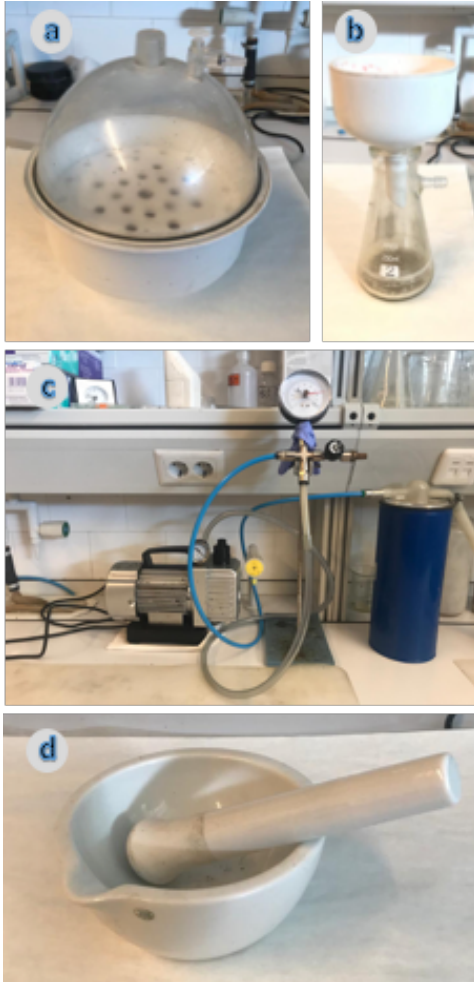
Figura III-12 Equipamiento para las pruebas a) cámara de vacío (b)embudo (c) compresor (d)mortero. Fuente: Elaboración propia.
