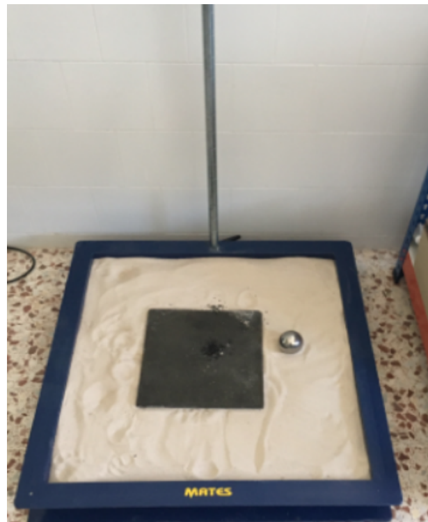
Figura III-19 Foto III 16 Probeta en lecho de arena lista para ensayar. Fuente: Elaboración propia.
