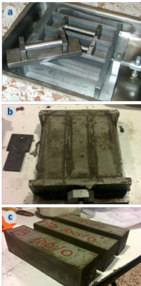
Figura III-5 Elementos para las probetas a) Moldes de hierro utilizado para la fabricación de las probetas. b) moldes con probetas c) probetas identificadas.
