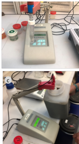
figura III-8 Equipos para las pruebas de medidas de pH. (a) composiciones a ensayar (b) pHmetro (c) toma de medida a composición.
