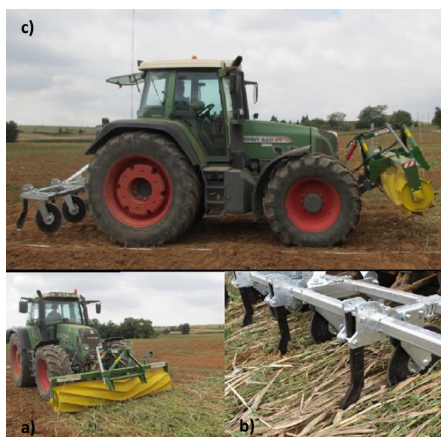
Figura 1. Roller crimper + llaurada en línia. Detall del roller-crimper (a); eina per a la llaurada en línia (b); tractor equipat amb el roller crimper + eina per a la llaurada en línia (c). Fotos de David Navarro.
