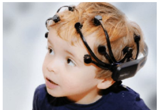
Figura 12. Sistema Emotiv para el análisis de emociones y ondas cerebrales
