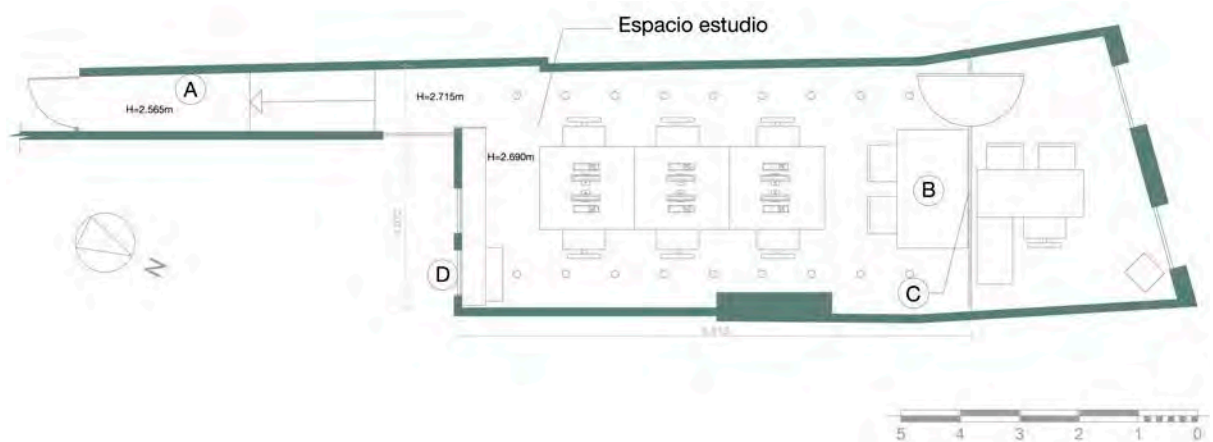
Figura II.2.6. Planta del espacio estudio, situación inicial: A. Ubicación del muro de emociones diaria, B. Mesa de reuniones, C. Muro acristalado dotado de pantalla para videoconferencias, D. Ventanas bloqueadas.
