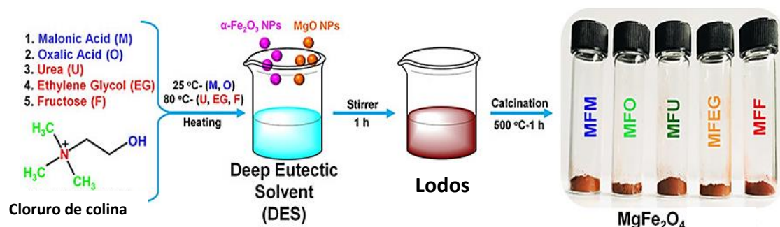
Figura 10. Ruta de síntesis de nanopartículas de MgFe_2O_4 utilizando como medio de reacción diferentes DES. 40
