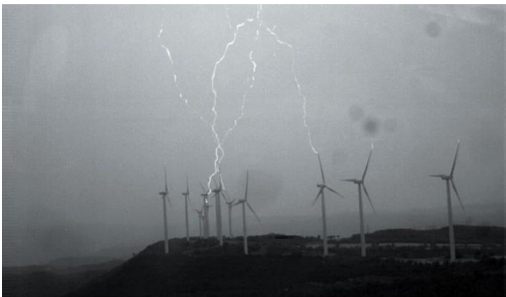
Figura 11. Líderes ascendentes provocadas por aerogeneradores (Montanyà et al., 2014).
