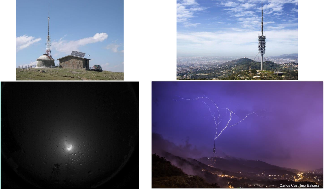
Figura 8. Fotografías de antenas con afectaciones de rayos. A la izquierda, fotografía con un objetivo ojo de pez de un líder ascendente en el Niu de l'Àliga (Bagà, Barcelona). Créditos a Lightning Research Group (UPC). A la derecha, líder ascendente en la torre de comunicaciones de Collserola (Barcelona). Créditos a Carles Castillejo ( @Castibalseira ).
