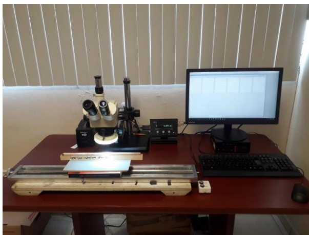
Figura 12. El sistema de medición VELMEX es un instrumento estándar para medir el ancho de los anillos de crecimiento. Este equipo consta de una platina de fase deslizante, la cual está conectada a una computadora que tiene instalado el programa Measure J2X versión 4.2. Con la ayuda de un microscopio, que tiene una retícula graduada en forma de cruz en uno de los oculares, se marca el inicio del anillo de crecimiento, así como el límite de la madera temprana y la madera tardía. Este procedimiento se repite en cada uno de los anillos. Finalmente, el programa genera tres bases de datos, los cuales tendrán los valores de medición de anillo total, madera temprana y madera tardía (Fotografía de Ricardo Miranda Briones).
