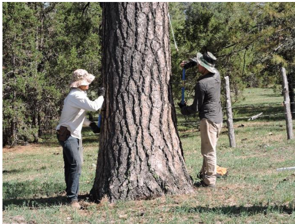
Figura 11. Para extraer la muestra, el taladro Pressler se ubica en lo que se cree puede ser la médula del árbol. Para iniciar la extracción de la viruta, la punta de la barrena del taladro se presiona firmemente contra la corteza, colocada en ángulo recto (90°), perpendicular al tronco, y el mango se gira en el sentido de las manecillas del reloj. Una vez que la punta de la barrena se fija firmemente en la madera, sólo se necesita presión para seguir girando el mango. (Fotografías de Julián Cerano).
