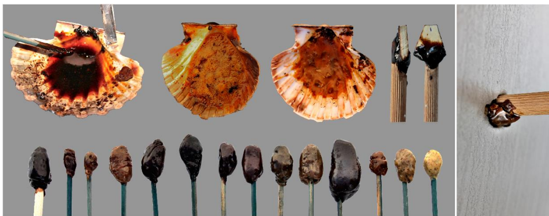
Figura 4.28. Aspecto final de los adhesivos experimentales, tanto en el recipiente como en el aplicador. A la derecha (arriba) se muestran las piezas experimentales del experimento de resistencia, así como el efecto de la vitrificación de la mezcla utilizada en uno de los proyectiles, el adhesivo estalla tras el impacto.
