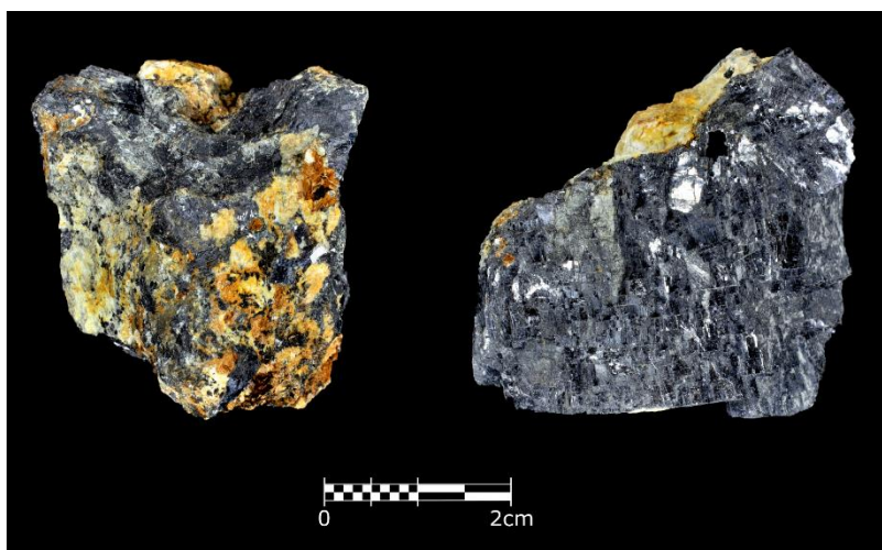
Figura 4.15. Dos ejemplares de galena procedentes de Mina Mariquita (El Molar, Tarragona). El ejemplar de la izquierda con más impurezas y menor contenido en plata, y el de la derecha con importantes brillos producidos por su mayor contenido en plata.
