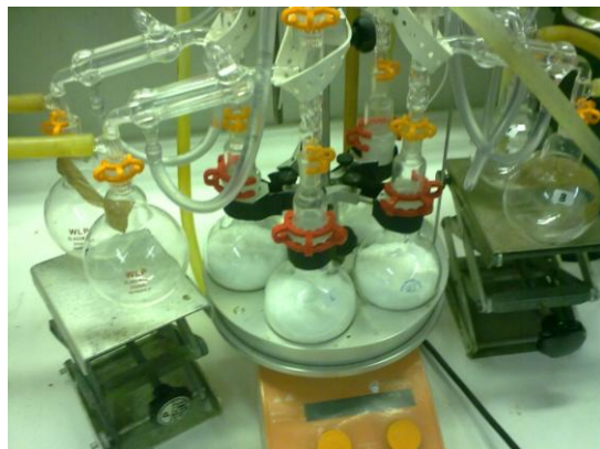
Imatge 9.1.- Muntatge del starfish per a l'estudi sobre la síntesi de polièster
