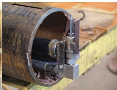
Figura 3-6 Cabezal de corte en tubería, con corte a 3800bar y caudal 4litros/min (Safe-Cut).
