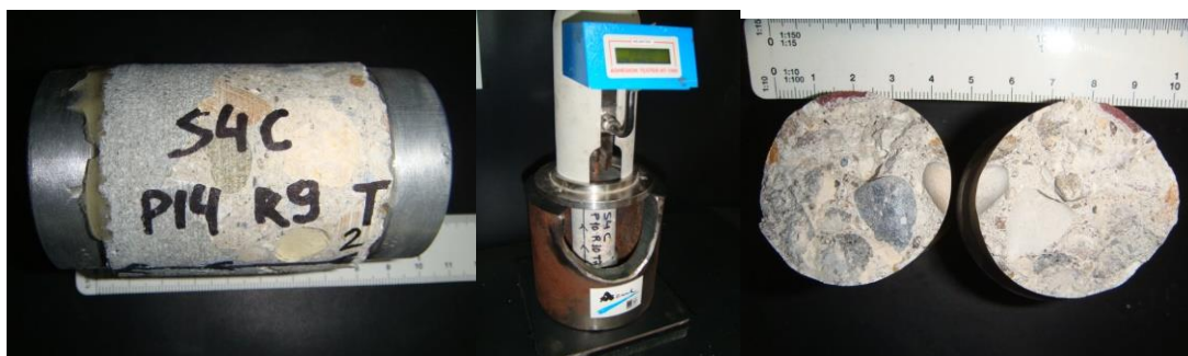
Figura 5-19 Ensayos a tracción pura (a) probeta con hormigón soporte y mortero (b) gato de extracción (c) probeta ensayada
