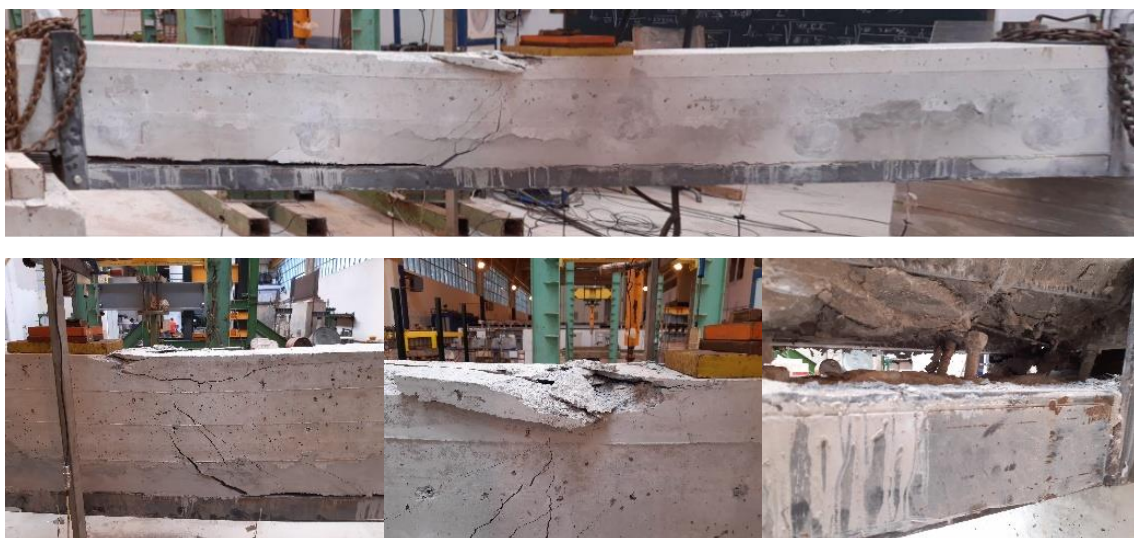
Figura 5-60 Viga 4. Vista general del fallo CDC (a), fallo por arrancamiento de conectores a cortante y tracción (b), agotamiento en cabeza comprimida y plastificación perfil y ausencia de conectores en extremos por fallo constructivo (d)
