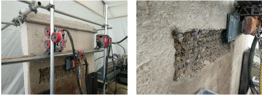
Figura 5-14 Prototipos de robot trepante en instalación fabricante de los equipos.
