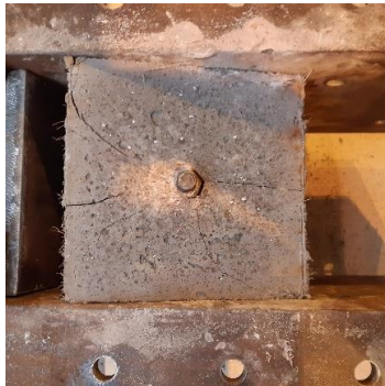
Figura 5-45 Rotura de probetas (izq) y fallo del conector tras demolición (dcha).
