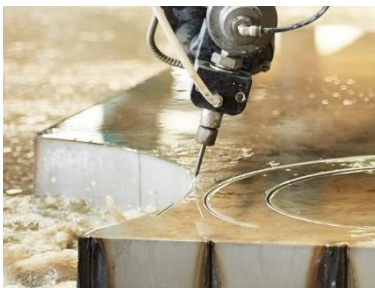
Figura 3-5 Ejemplo de corte de chapa con abrasivo. (JetEdge Waterjets).
