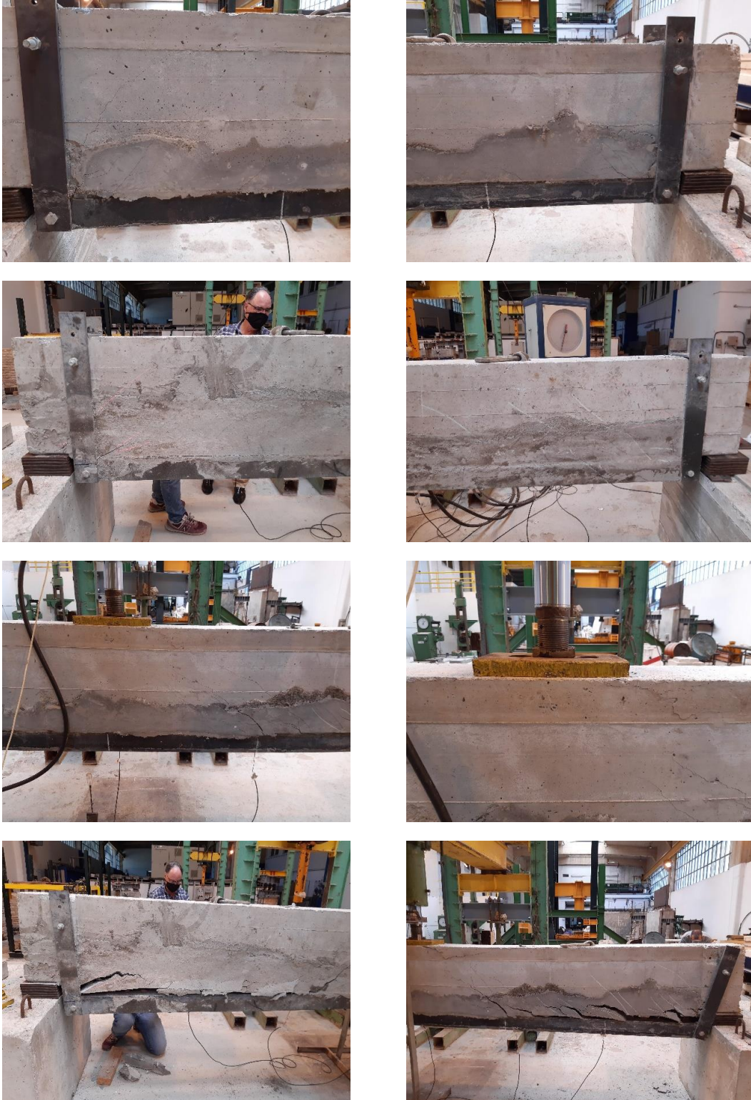
Figura D-1 Secuencia de rotura para viga #1.
