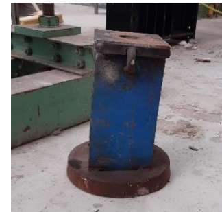
Figura 5-28 Agotamiento del perfil auxiliar del gato (fallo prematuro).
