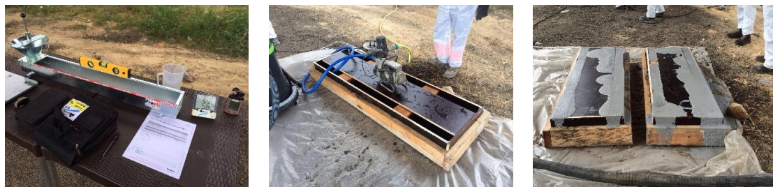
Figura 3-68 Ensayo de fluidez en obra (a)(AZUL) y ensayo de inyección de mortero en inmersión en sifón (b) (AZUL).
