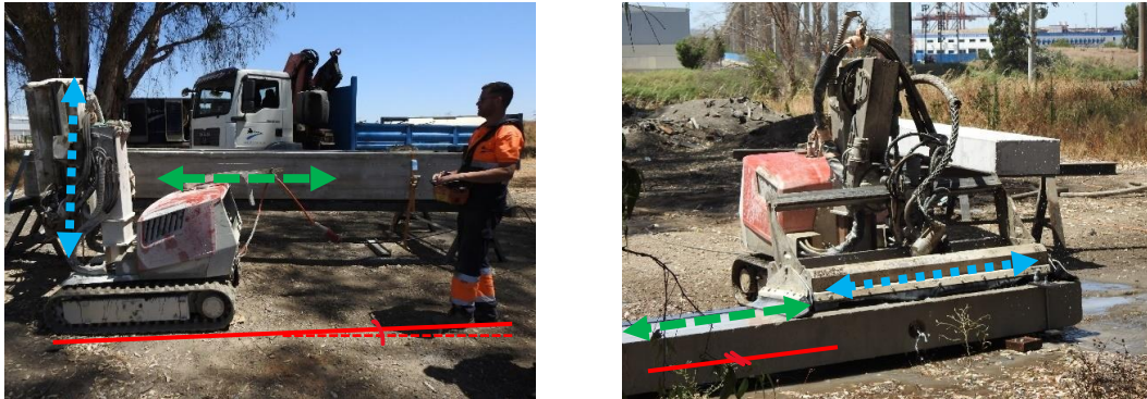
Figura 5-52 Movimiento del robot en posición vertical y horizontal.
