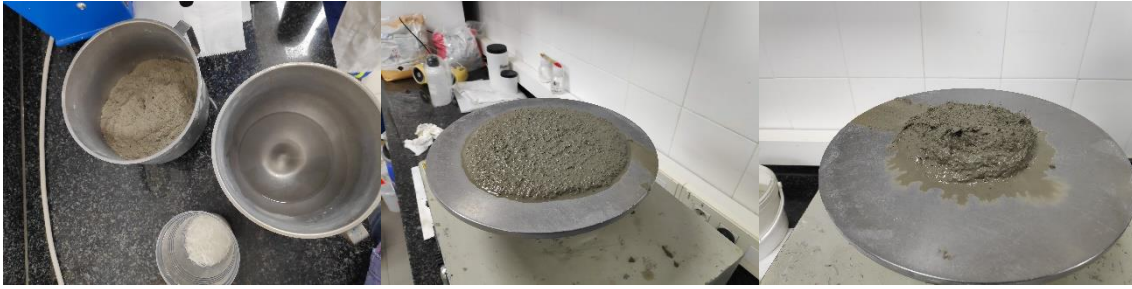
Figura 3-63 Vista de ensayo de consistencia modificando contenido de fibras
