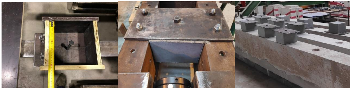
Figura 5-43 Detalle de fabricación de la probeta (a), acopio (b) y posicionamiento en ensayo (c). Se aprecia la holgura de 2mm en cada cara de la probeta y el perfil.
