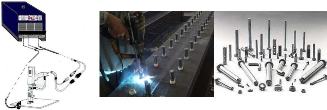
Figura 3-47 (a) Vista del equipo y procedimiento de soldadura de conectores (b) Tipología de anclajes (True Stud Welding, s.f.)
