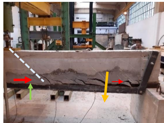
Figura 5-63 Pérdida de contribución de los conectores descendidos, debido a su nula contribución a tracción.
