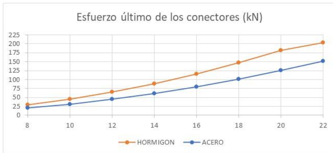
Figura 5-46 Curvas estimadas de resistencia a cortante según EC4 y modo de fallo : cortante máximo (kN) y diámetro conector (mm)
