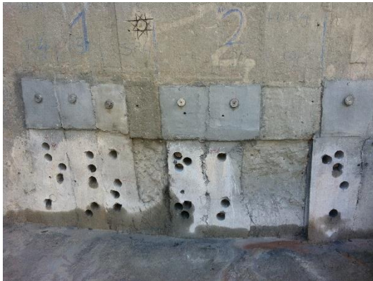
Figura 5-17 Ensayos a tracción pura.
