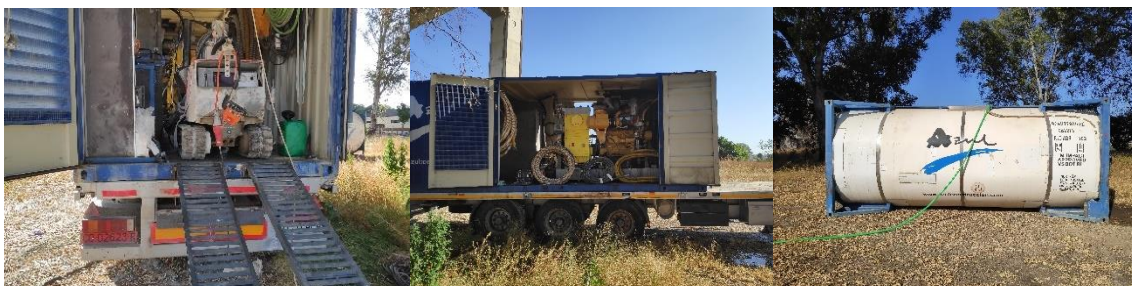
Figura 3-29 Equipos usados durante la campaña experimental: camión y robot (a), grupo de presión (b) y depósito de agua (c).
