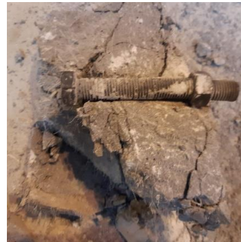
Figura 5-45 Rotura de probetas (izq) y fallo del conector tras demolición (dcha).
