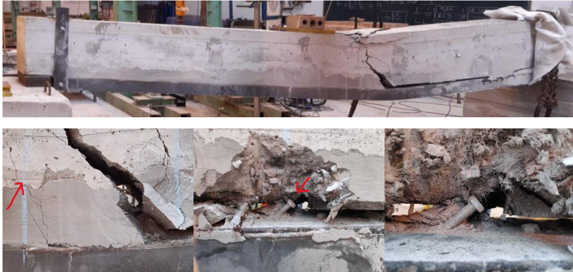
Figura 5-59 Viga 3. Vista general del fallo CDC (a), perfecta adherencia y cosido de las fibras en el mortero (b), fallo por arrancamiento de conectores a cortante y tracción (c) y detalle del conector y la matriz de mortero con fibras (d).
