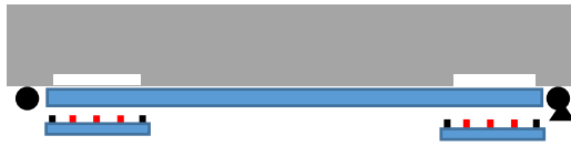
Figura 4-9 Instalación de conectores con chapas secundarias tras hidrodemolición en ventanas.
