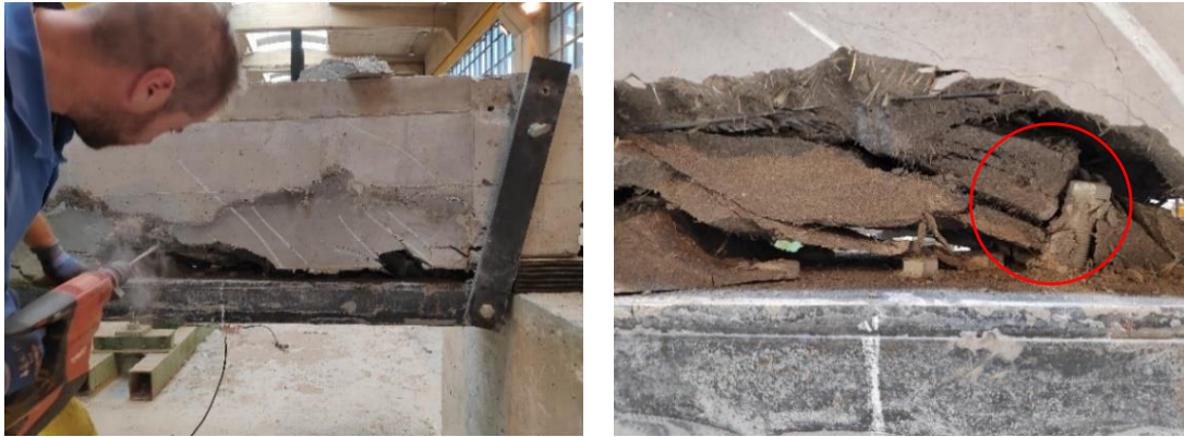
Figura 5-54 Secuencia del ensayo: (a) aplicación de carga a centro luz (b) medida tensiones a L/6 (c)(d) vista de las bandas extensométricas (e) repicado tras rotura para liberar zona de anclajes (f) rotura local de conector izado y conector descendido.
