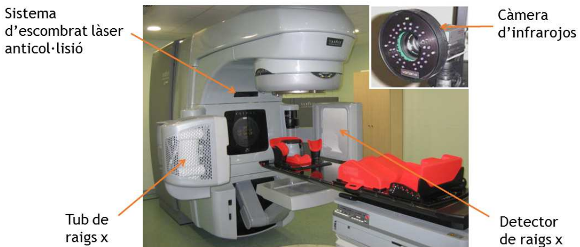
Figura 7: Configuració avançada d'un linac de radioteràpia. En un accelerador Varian Clinac iX de l'ICO-Girona, es mostra el sistema de CBCT consistent un tub de raigs x i un detector muntats perpendicularment al feix de tractament. Acorrats a la taula es disposen elements d'immobilització del pacient per assegurar la reproductibilitat del posicionament al llarg de les diverses sessions de tractament. Un sistema d'escombrat làser evita possibles col·lisions del capçal amb la taula o el pacient en tècniques rotacionals. Una càmera d'infrarojos muntada en la paret als peus de la taula permet, mitjançant elements reflectors situats sobre el tòrax del pacient, realitzar tècniques de gating respiratori. Elaboració pròpia.
