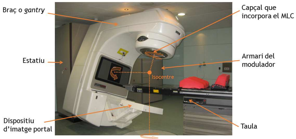
Figura 4: Configuració bàsica d'un linac de radioteràpia. Es mostren els elements que componen un accelerador Varian Clinac 2100 C/D de l'Institut Català d'Oncologia (ICO) de Girona, capaç de realitzar tècniques 3DCRT. El braç, ancorat a un estatiu, i la taula giren per poder incidir amb el feix de radiació sobre l'àrea desitjada del pacient. El capçal, que incorpora el MLC, permet conformar el feix a la forma del tumor des d'aquest angle d'incidència. Els eixos de gir intersequen en l'isocentre de la màquina. Un modulador administra l'energia necessària per produir els polsos de radiació. La unitat incorpora un dispositiu per obtenir imatges internes del pacient amb el propi feix de radiació, anomenades imatges portals, que serviran per establir de forma precisa la localització dels camps segons s'ha determinat en la fase de planificació del tractament. Elaboració pròpia.
