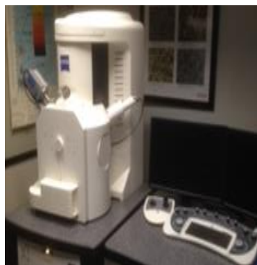
Figura 3.2 Microscopio electrónico Zeiss EVO MA25 con detector EDS \alpha -Flash 5010 de Bruker.
