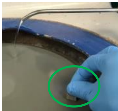
Figura 4.29 Proceso de desbaste de una muestra en verde.
