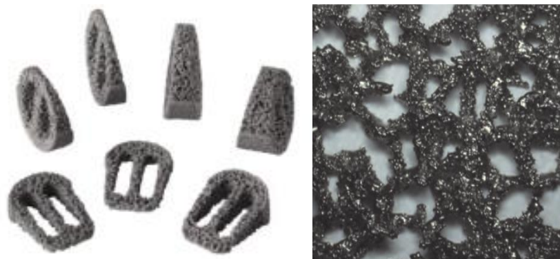
Figura 2.3 Estructura porosa obtenida por Osseo Ti imitando al hueso trabecular y cuña Unite3D [81].
