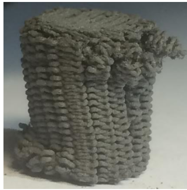
Figura 4.26 Cilindro poroso (impreso con la tinta final) tras el ensayo de compresión.
