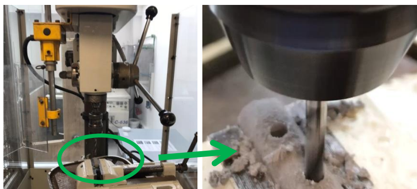
Figura 4.31 Proceso de taladrado en verde.
