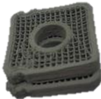
Figura 8.61 Defecto escalón producido por el cambio de jeringa.
