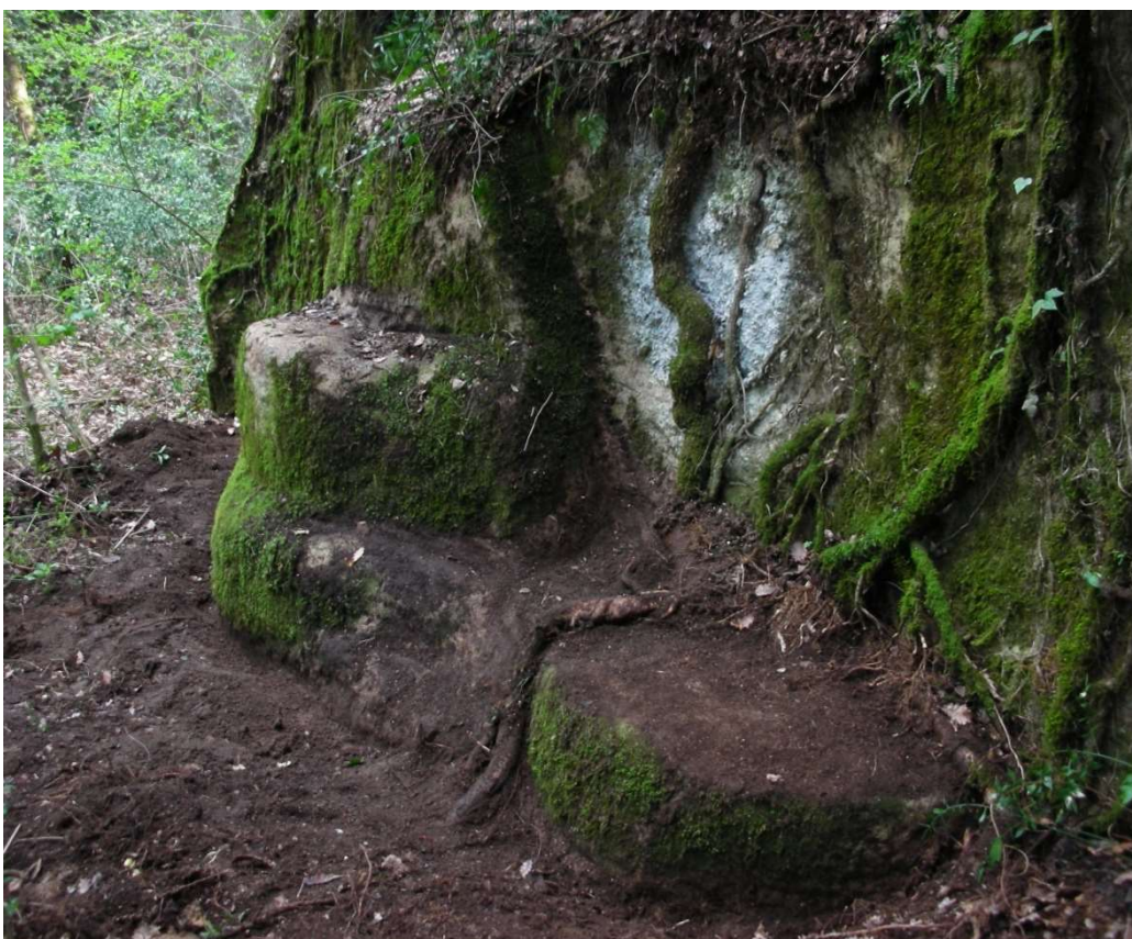
Figura. 38. Detall de blocs de moleres abandonats a mig procés d'extracció. Exemple del Clot de les Moleres (Sarrià de Dalt).
