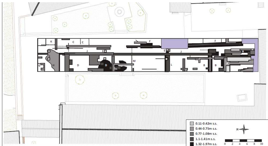
FIGURA 12.106: diagrama de lectura del georadar realitzat entre la Biblioteca i les Cases Noves del monestir de Poblet (SALA, R.; GARCIA, E.; TAMBA, R. 2011).
