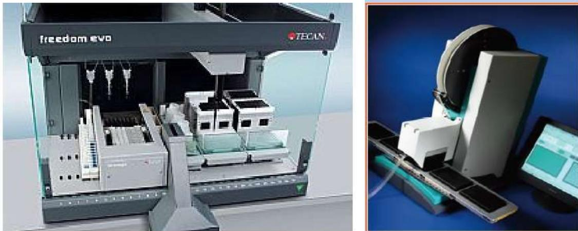
**Figura 3.11:** *Izquierda:* Robot dispensador de soluciones precipitantes. *Derecha:* Robot dispensador de gotas.
