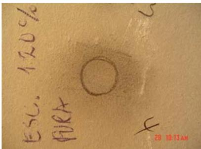
Foto 6.5 Huella de la probeta R (42-44) de escayola 100% + agua al 120%
