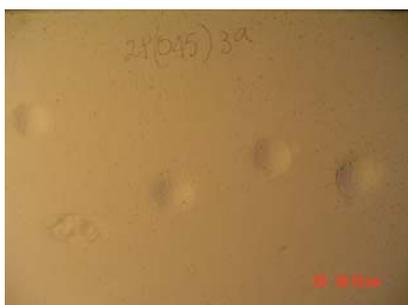
Foto 6.7 Huellas sobre probeta con residuos mezcla 45 de placa
