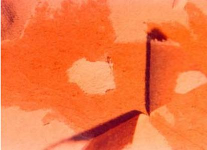
Foto 6.3 Adhesividad entre papel y núcleo en una probeta de placa comercial
