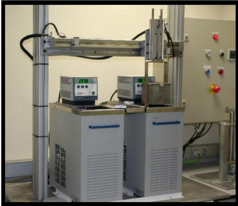
Figura 12. Máquina de envejecimiento artificial usada en esta investigación.
