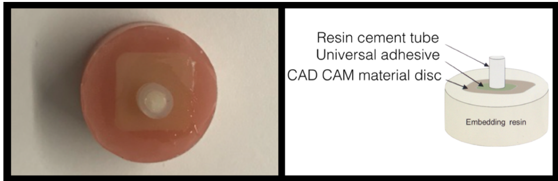
Figura 11. Esquema de un espécimen tras el proceso de cementado y muestra de cerámica híbrida tras ser cementada.
