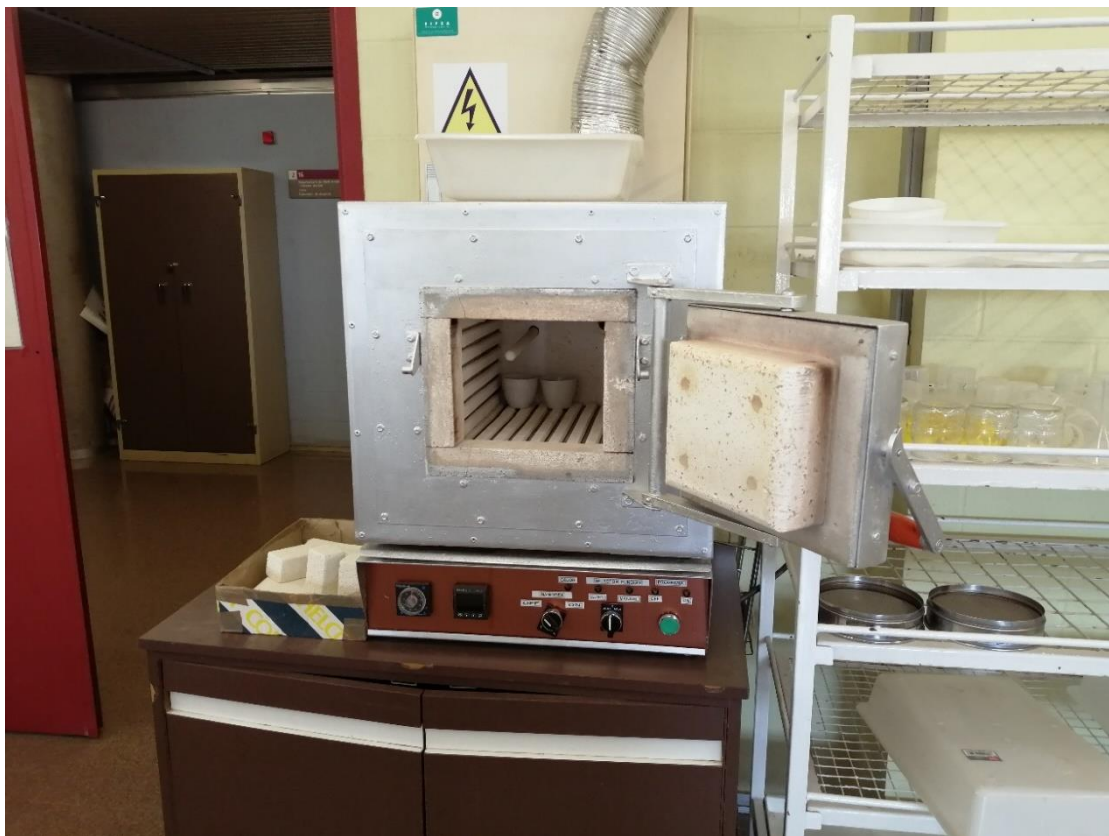
Figura 3.27: Horno tipo mufla del laboratorio de Anàlisi de sòls, aigües, material vegetal i residus orgànics
