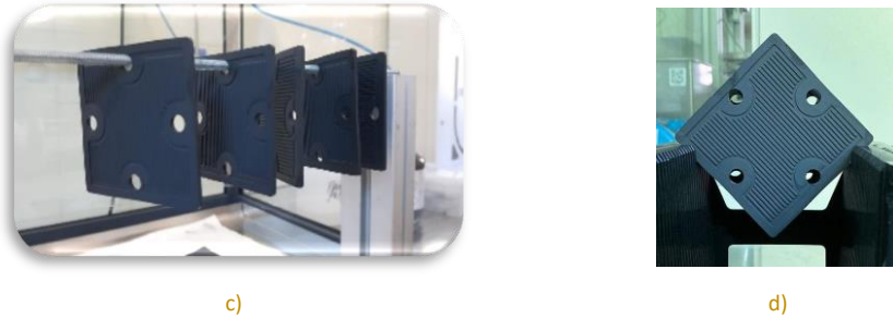
Fig. 28 Etapas del proceso de deposición por EPD: a) Detalle de los electrodos y el interconector, b) Detalle del interconector recubierto entre los electrodos, c) Fase de secado, d) Interconector recubierto por EPD y secado
