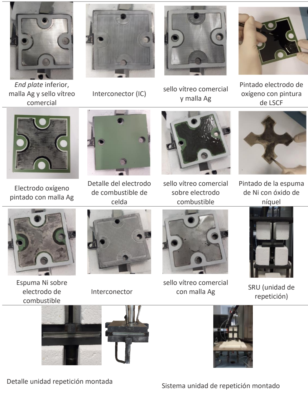
Fig. 151 Recopilación de imágenes donde se muestra con detalle cada una de las etapas a seguir para poder montar una SRU para medir en SOFC o SOEC
