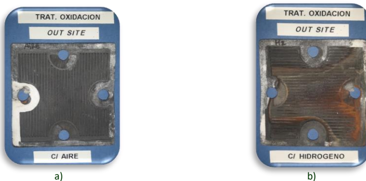
Fig. 142 Imagen interconector oxidado previamente durante 100h a 800°C y tras más de 250h a 800°C: a) contacto con aire, b) contacto con combustible
