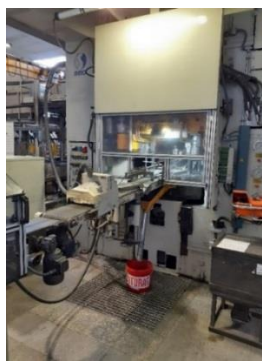
Fig. 83 Imagen de la prensa hidráulica de 600 Tm ubicada en AMES Montblanc con la que se han prensado los interconectores de 87*87 mm diseñados en este estudio
