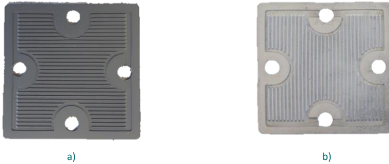
Fig. 100 Imagen del interconector recubierto mediante roll-coating : a) Cuatro capas de suspensión al 50% en terpineol, b) Interconector recubierto y sinterizado
