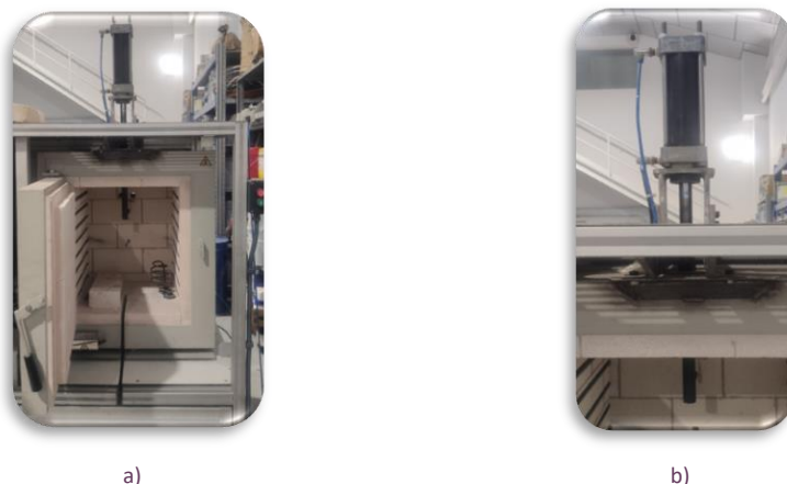
Fig. 128 Sistema de aplicación de carga neumática: a) Ubicación en el equipo, b) detalle del pistón neumático
