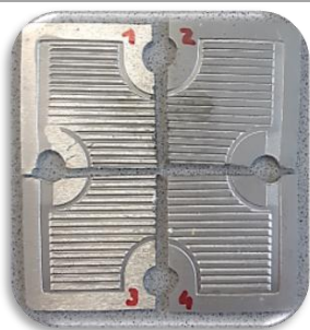
Fig. 90 Imagen del interconector sinterizados a dos niveles y rectificado por ambas caras y con los taladros de la entrada/salida de gases
