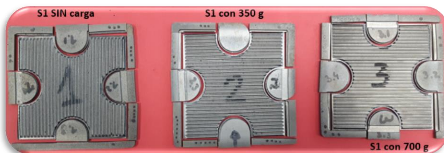
Fig. 88 Detalle de las diferentes zonas obtenidas tras el corte con hilo para el estudio de densidades tras el sinterizado del interconector a uno, dos y tres niveles
