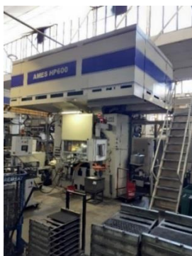
Fig. 83 Imagen de la prensa hidráulica de 600 Tm ubicada en AMES Montblanc con la que se han prensado los interconectores de 87*87 mm diseñados en este estudio
