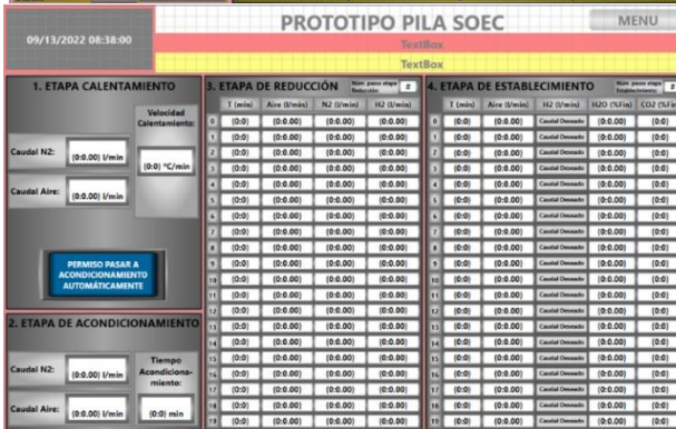
Fig. 135 Detalles de PLC: a) menú de inicio, b) ejemplo de protocolo programado
