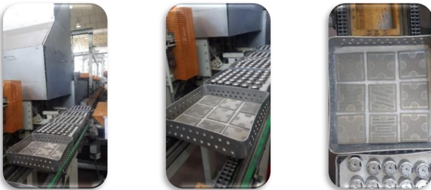
Fig. 87 Imágenes de las gavetas metálicas con las placas cerámicas de cordierita-mullita con los interconectores prensados sobre ellas a punto entrar en el horno de sinterizado de alta temperatura
