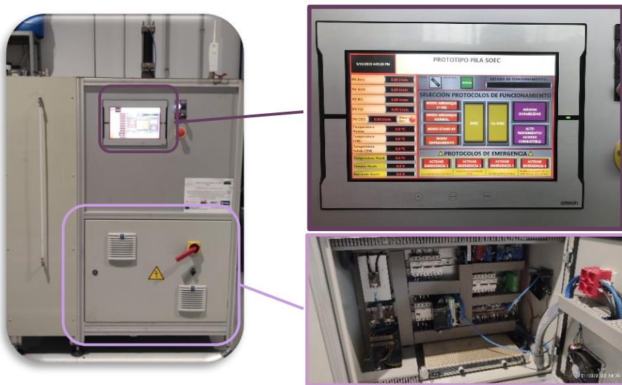
Fig. 134 Parte frontal del prototipo electrolizador donde se aprecia con detalle el PLC y el panel de control del equipo. En la parte inferior del frontal se encuentra toda la zona eléctrica y fuente de alimentación
