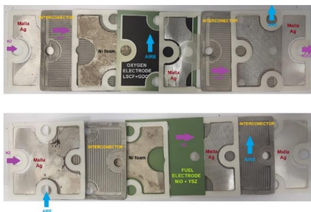
Fig. 149 Imagen de todos los componentes descritos que conforman la SRU de este estudio con detalle de entradas/salidas de gases y peculiaridades de cada cara del componente
