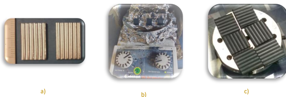
Fig. 26 Muestras de Fe22Cr: a) 15*15*2.3 mm sinterizadas b) durante el proceso de recubrimiento sobre placa calefactora, c) muestras recubiertas tratadas térmicamente preparadas para observar al SEM
