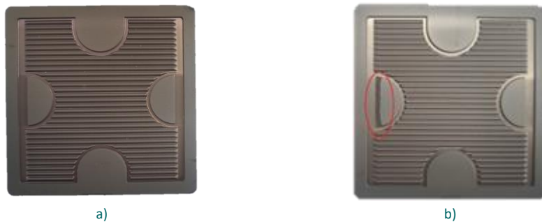
Fig. 86 Imágenes del interconector prensado en la prensa de 600 Tm: a) Interconector prensado en condiciones óptimas, b) Detalle del defecto por falta de pulido del punzón superior
