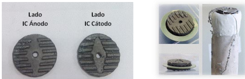
Fig. 118 Imagen de muestra con canales: a) recubierta con \text{MnCo}_2\text{O}_4 , b) Diferentes vistas del sistema (Fe22Cr/MC12 – celda – Fe22Cr/MC12) como SRU
