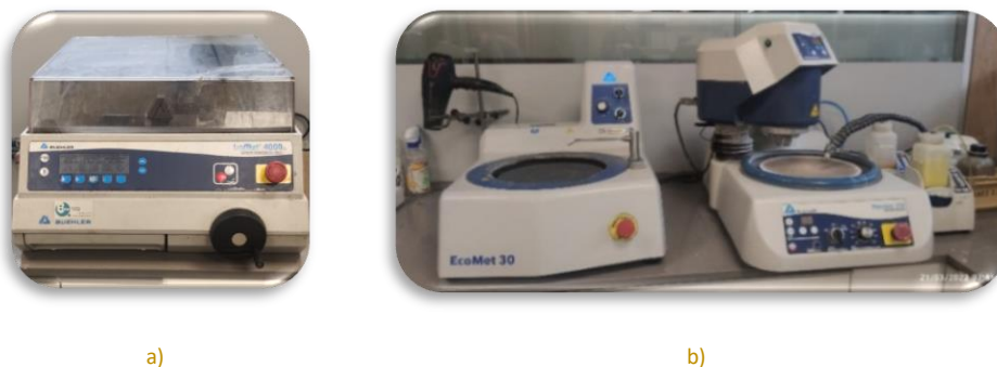
Fig. 40 Imágenes de equipos: a) Cortadora de precisión Buehler, b) Pulidora manual y automática de Buehler
