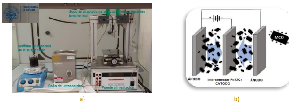
Fig. 27 a) Componentes de la instalación de EPD del Politécnico di Torino, b) Esquema adaptado [222] del proceso de EPD con dos electrodos
