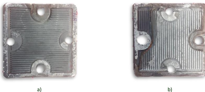
Fig. 145 Imagen de las dos intercaras de un IC tras más de 400h a 800°C: a) Cara contacto con atmósfera de aire, b) Cara en contacto con la atmósfera reductora
