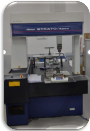
Fig. 46 Imagen de máquina de tres coordenadas y detalle del palpador de medida
