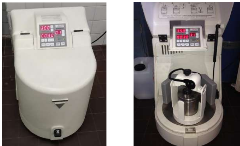
Figura 3.2 Molino planetario Fritsch Mono Mill PULVERISETTE 6 classic line utilizado en la realización de las aleaciones HEA.
