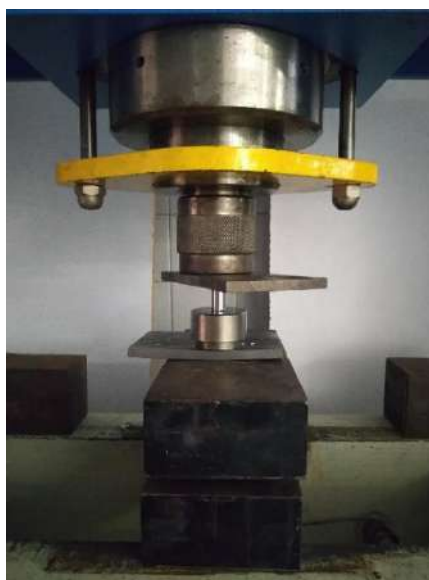
Figura 3.6 Montaje del molde en la prensa
