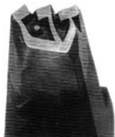
33. Pormenor de punção, de um caracter hebraico (moderno?) gravado para a Imprimerie royale de Paris. © Imprimerie nationale, Cabinet de poinçons, Paris.
