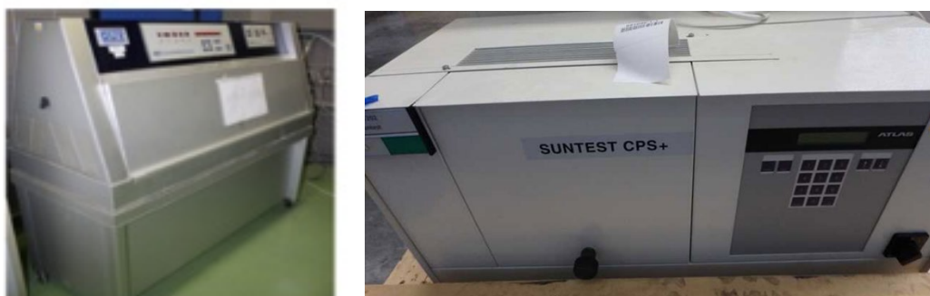
Figura 3. Cámaras de envejecimiento utilizadas
