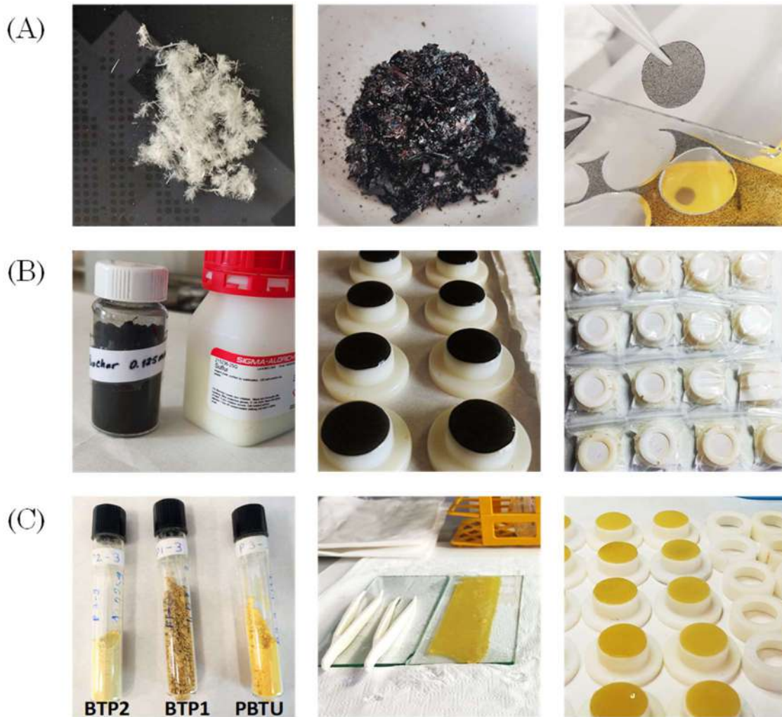
Figura 20. (A) Biocarbón obtenido a partir de plumas (FBC) para posterior preparación de geles de unión. (B) Preparación de dispositivos DGT-SBC. (C) Preparación de geles de unión con BTP1.
