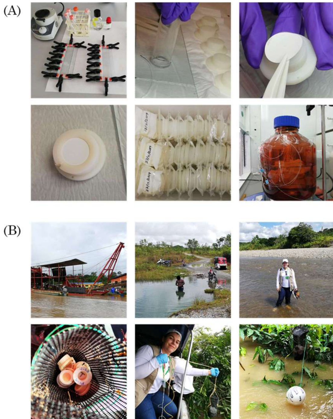
Figura 15. (A) Materiales para la preparación de hidrogel, montaje de dispositivos DGT y calibración mediante ensayo de serie temporal en condiciones de laboratorio. (B) Muestreo en el río Atrato y AMPs.
