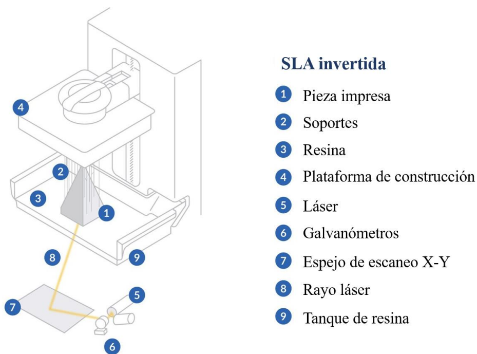
Figura 1.7. Esquema representativo de la estereolitografía invertida. Esta configuración emplea un tanque transparente y antiadherente para almacenar la resina líquida curable y una plataforma de construcción vertical que baja hacia el fondo del tanque, para empezar la impresión de las capas hacia arriba. En la parte inferior de la máquina se encuentra un láser UV que apunta a dos galvanómetros de espejo. Luego, esta luz se dirige a otro espejo que dirige la luz hacia arriba, al fondo del tanque, para curar la resina. Entre cada capa, la pieza se separa del tanque, permitiendo que la resina fluya de nuevo a su lugar [51,52].
