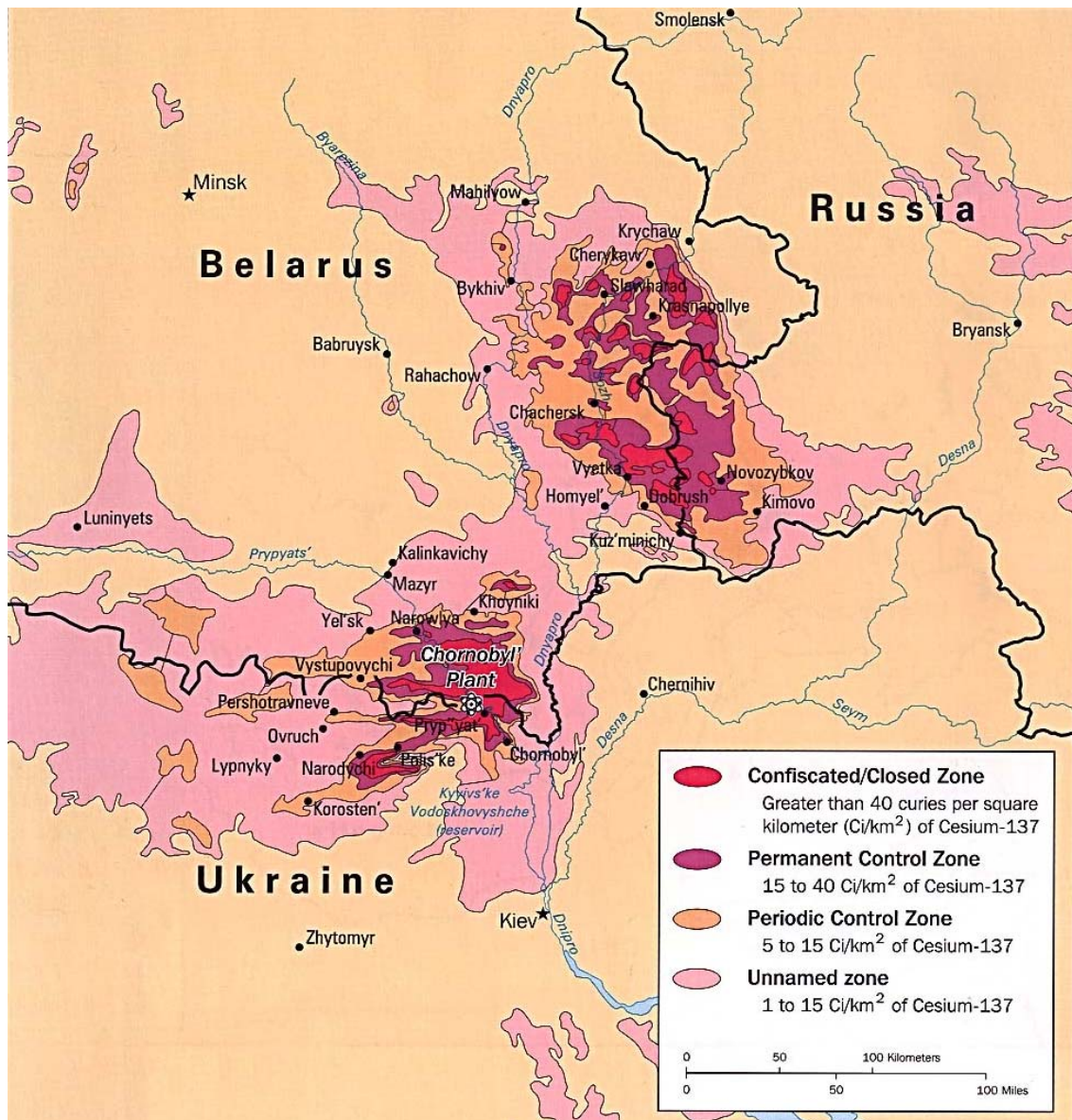
Figura 1.7. Clasificación de las diversas zonas controladas en función de la contaminación existente de ^{137}\text{Cs} en 1998 (De Cort et al., 1998).
