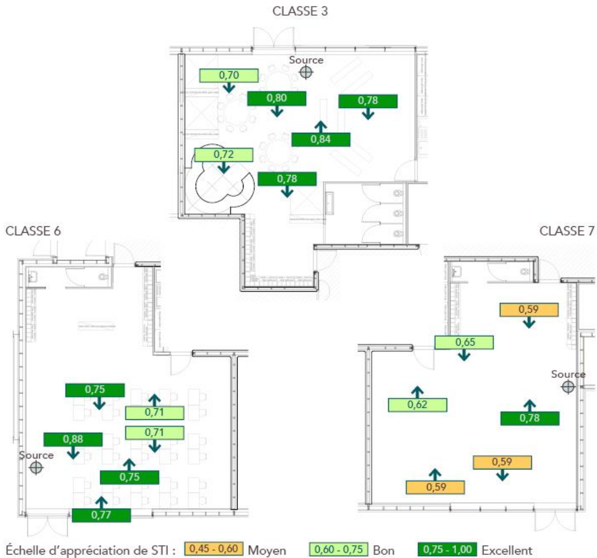
Figure 102 Valeurs d'intelligibilité à la parole - Speech transmission Index (STI) – Salles de classe de Bouvron.
