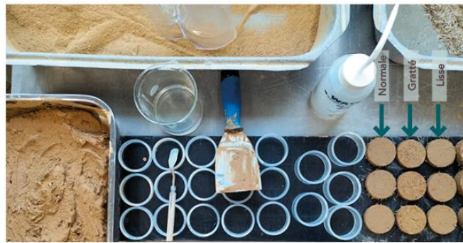
Figure 118 Exemple de réalisation des éprouvettes avec trois finitions différentes.
