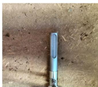
Figure 308 Mesures in situ du coefficient d'absorption acoustique par fréquence et photographies de la mesure. Mur en bauge (partie haute) – Bouvron.
