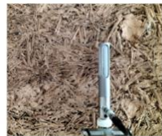
Figure 314 Mesures in situ du coefficient d'absorption acoustique par fréquence et photographies de la mesure. Mur en terre et chanvre (terre allégée) – Baulon.
