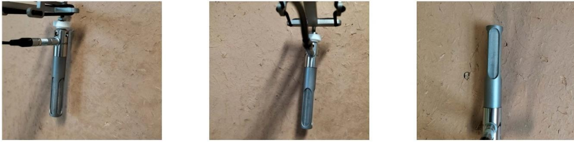
Figure 323 Mesures in situ du coefficient d'absorption acoustique par fréquence et photographies de la mesure. Enduit terre sur bottes de paille – Mouais.
