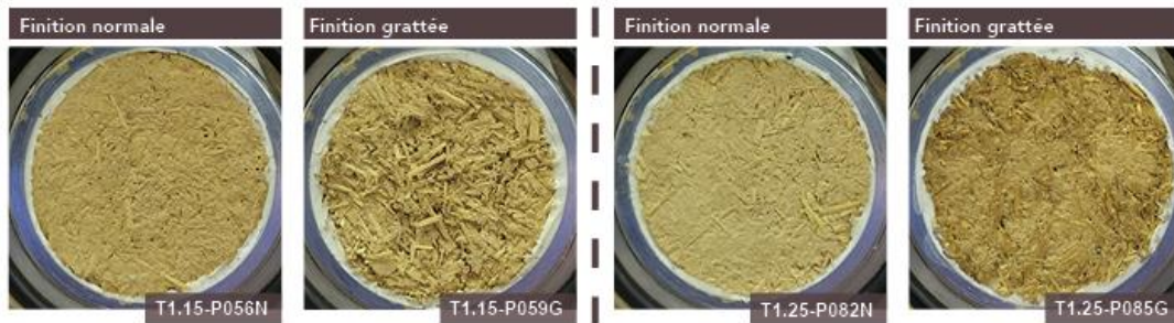
Figure 132 Aspect de surfaces des éprouvettes de la terre 1 avec 25% de paille et 15% de paille.
