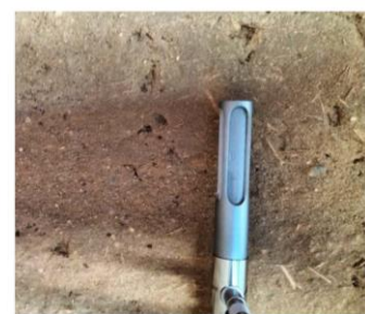
Figure 308 Mesures in situ du coefficient d'absorption acoustique par fréquence et photographies de la mesure. Mur en bauge (partie haute) – Bouvron.
