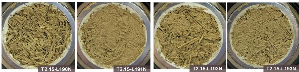
Figure 124 Comparaison de l'aspect de surface des éprouvettes d'un même mélange. Terre 2 – 15%Lin.
