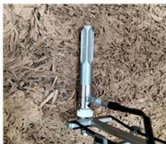
Figure 314 Mesures in situ du coefficient d'absorption acoustique par fréquence et photographies de la mesure. Mur en terre et chanvre (terre allégée) – Baulon.
