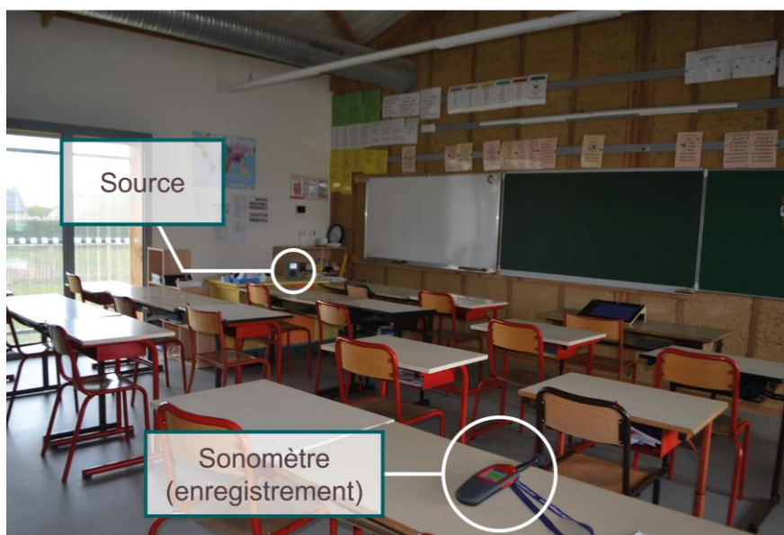
Figure 54 Exemple de mesure de STI avec placement de la source et le sonomètre.
