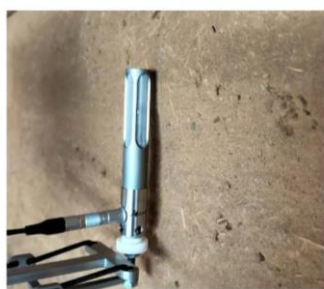
Figure 308 Mesures in situ du coefficient d'absorption acoustique par fréquence et photographies de la mesure. Mur en bauge (partie haute) – Bouvron.
