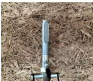
Figure 314 Mesures in situ du coefficient d'absorption acoustique par fréquence et photographies de la mesure. Mur en terre et chanvre (terre allégée) – Baulon.
