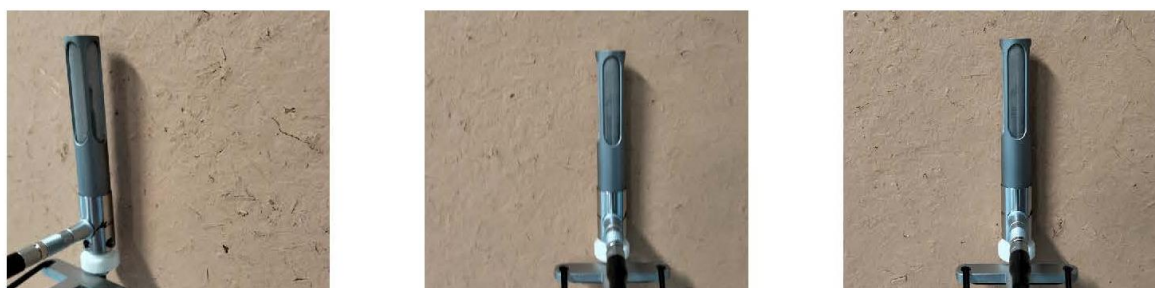
Figure 320 Mesures in situ du coefficient d'absorption acoustique par fréquence et photographies de la mesure. Enduit terre sur support terre-paille – Mouais.
