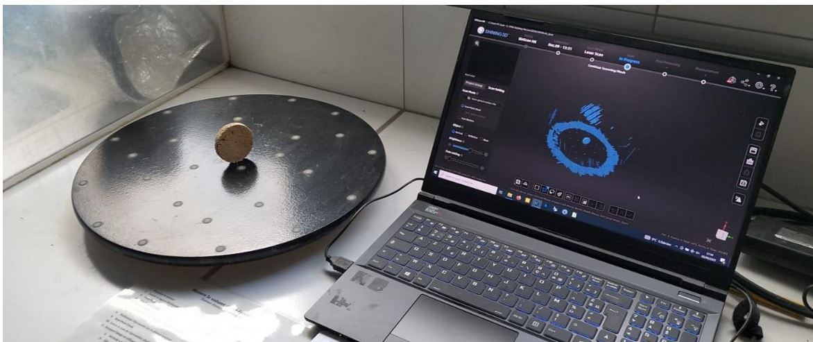
Figure 51 Calcul du volume par Scanner 3D Hybride Shining 3D Einscan HX.
