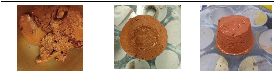
Figura 26. Ensayo experimental para determinación de L/S mínimo.
