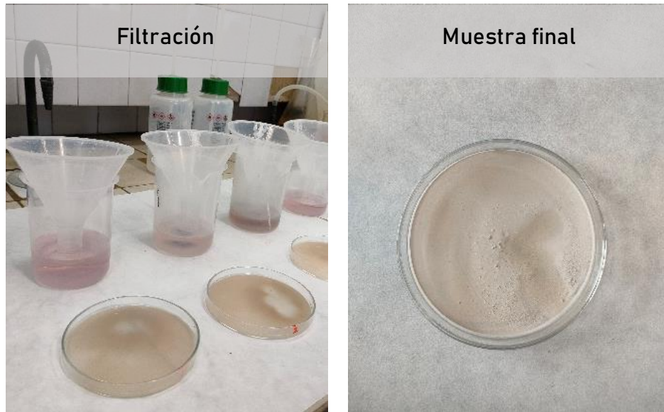
Figura 53. Procedimiento de extracción de C-S-H, C-A-S-H y N-A-S-H.
