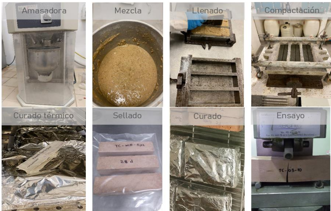
Figura 3. Procedimiento general para la fabricación de muestras de pastas y morteros.
