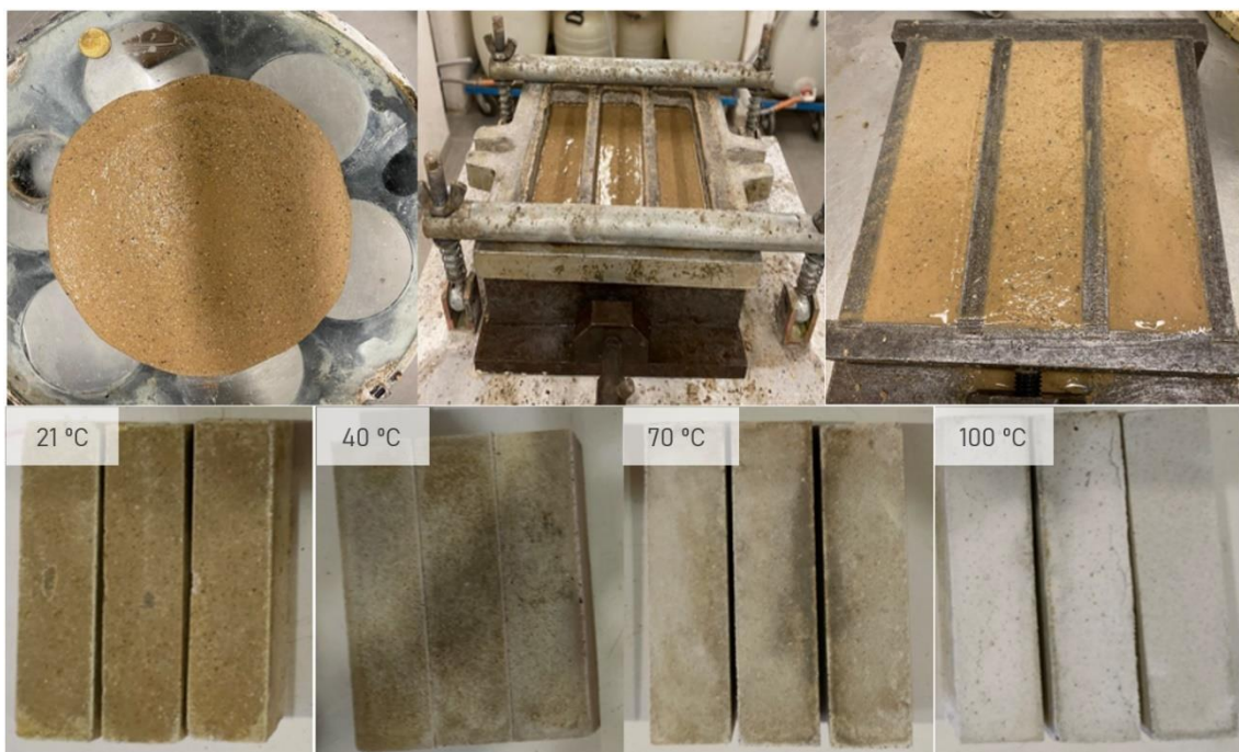
Figura 55. Preparación y muestras finales curadas a diferente temperatura después de 48h.
