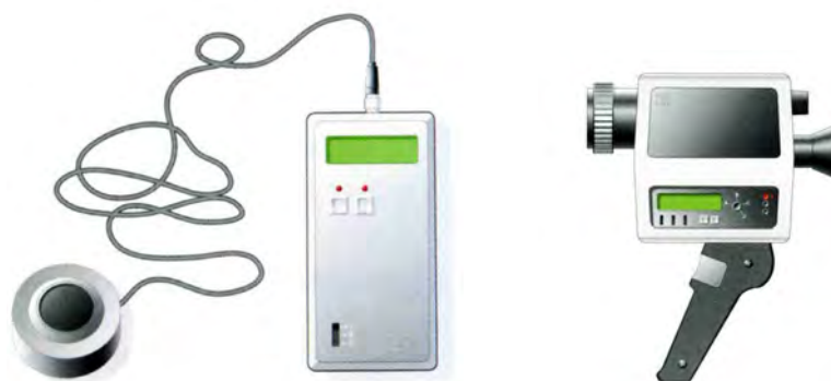
FIG.170, modelos standard similares al tipo de luxómetro y luminancímetro facilitados por la Escuela de Ingeniería de la UPC para realizar las mediciones puntuales. Las imágenes fueron obtenidas del texto Luminotecnia de la empresa INDALUX (2001)
