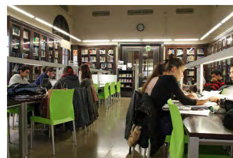
FIG. 217, La última reforma realizada durante el desarrollo de esta Tesis, permitió a la Facultad de Náutica de Barcelona renovar las luminarias de las mesas (sistemas de emisión indirecto), permitiendo reducir notablemente las luminancias extremas provocadas por las antiguas lámparas (sistema de emisión directo). Imágenes obtenidas el año 2019.
