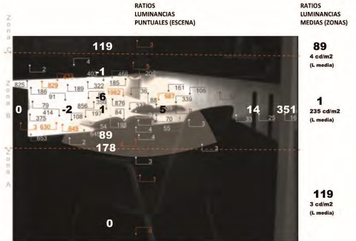
2. B.U.F.F. DEPÓSITO LUMINANCIAS PUNTUALES PLANTA 2 - PASILLO 1 MESA INDIVIDUAL FOTO 26 - 111.9 CAMPO VISUAL: TEXTO - ENTORNO
