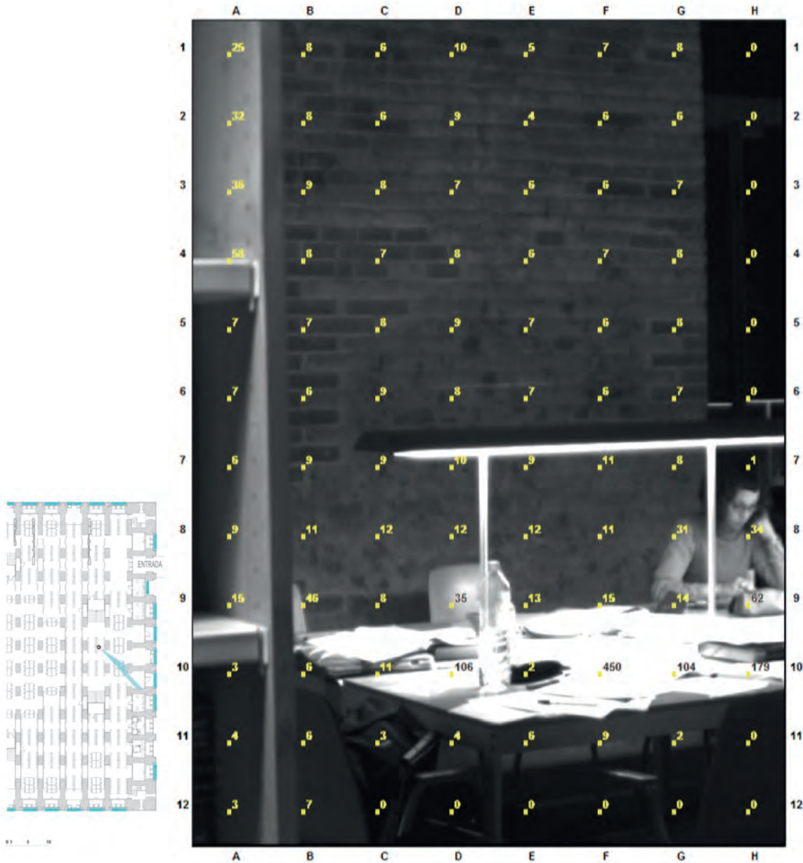
2. B.U.P.F. DEPÓSITO LUMINANCIAS DE LA ZONA PLANTA BAJA - PASILLO 1 MESA GRUPAL FOTO 15 - 15.f1.9 CAMPO VISUAL: TEXTO - ENTORNO TOTAL PUNTOS ANALIZADOS: 96
