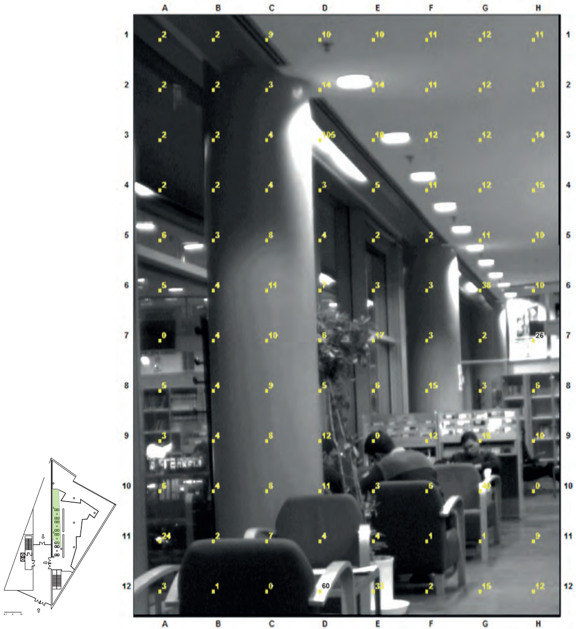
1. B.R.G.F. LUMINANCIAS DE LA ZONA PLANTA BAJA: SALA DE LECTURA FOTO 3 – 1.f1.9 CAMPO VISUAL: ENTORNO TOTAL PUNTOS ANALIZADOS: 96
