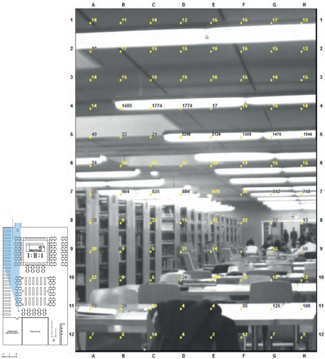
3. B.U.P.F. JAUME I LUMINANCIAS DE LA ZONA ZONA 1 SALA DE ESTUDIO FOTO 32 - 8.f1.9 CAMPO VISUAL: TEXTO - ENTORNO TOTAL PUNTOS ANALIZADOS: 96
