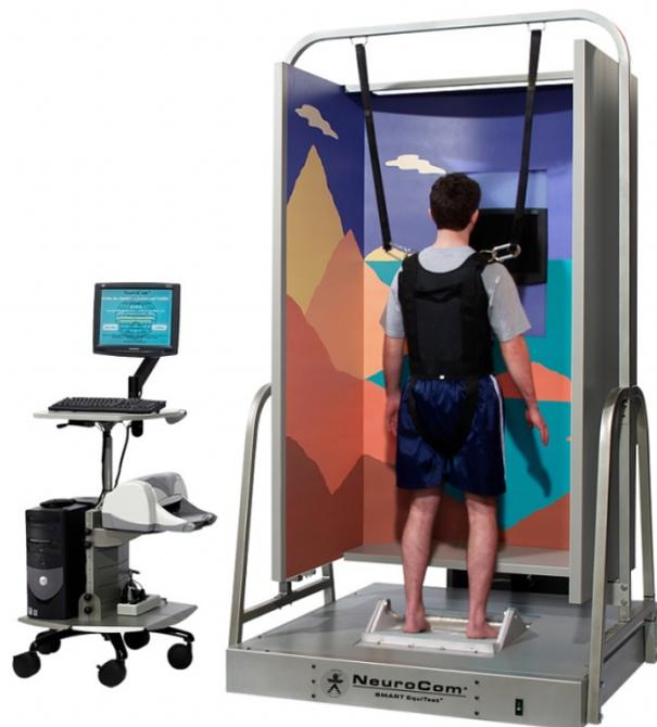
*Figura 7. Equitest System. Plataforma podológica que genera movimiento en rango variable y registra la respuesta de los sujetos.*
