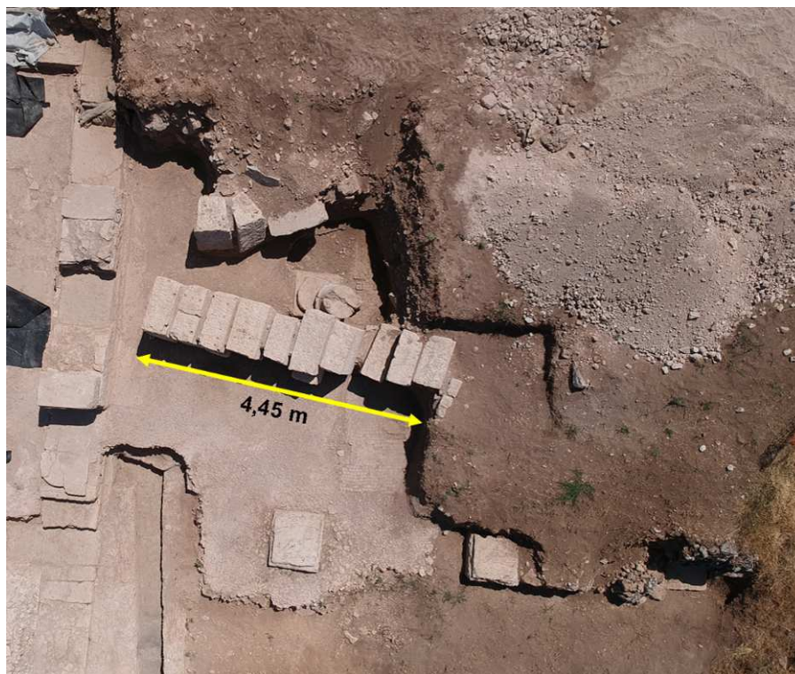
Figura 343. Vista aérea de la cadena de sillería perteneciente al CF-2 abatida sobre la palestra, con sus elementos conservando la posición estructural. Se ha indicado la longitud total. Fotografía y elaboración del autor
