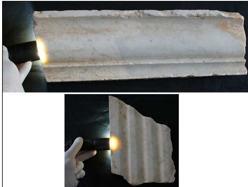
Figura 145. Imágenes del test de traslucidez aplicado a algunos elementos elaborados en mármoles blancos recuperados en el frigidarium del complejo termal de Valeria . Fotografías del autor.
