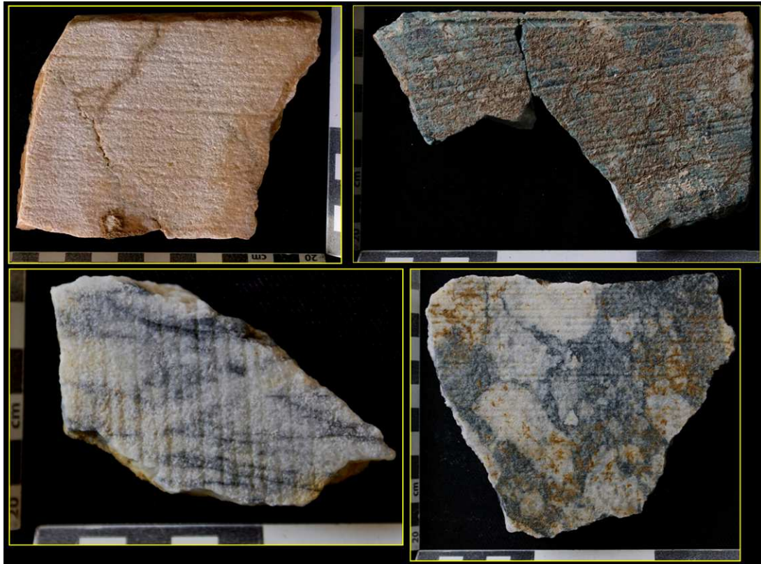
Figura 304. Muestra de piezas marmóreas que muestran en su cara posterior las marcas habituales del proceso de corte. Fotografías del autor.
