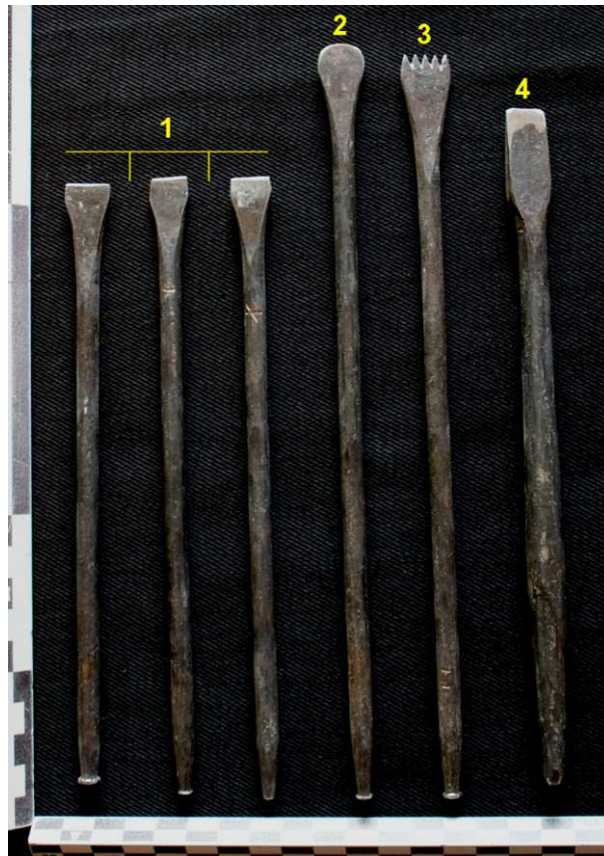
Figura 309. Distintos tipos de herramientas de labra usados en época romana 219 durante el proceso de elaboración de elementos marmóreos. 1.- cinceles lisos; 2.- cincel curvo o media caña; 3.- cincel dentado o gradina; 4.- cincel de calar o uñeta. Fotografía del autor.
