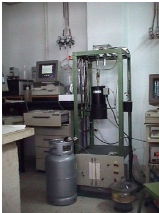
Figura 6.15. Analizador termogravimétrico utilizado para el estudio de la capacidad de adsorción de SO_2 y NH_3 de los materiales zeolíticos seleccionados.
