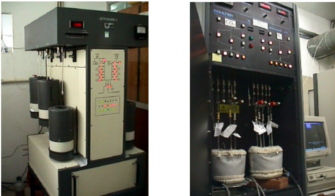
Figura 6.14. Instrumentación utilizada para la determinación de las isothermas de adsorción de N_2 a -196\text{ }^\circ\text{C} mediante un AUTOSORB DEGASSER- 6 stations (izquierda) y de CO_2 a 0\text{ }^\circ\text{C} con un OMNISORB 610 (derecha).
