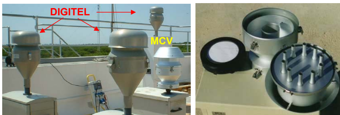
Figura 2.9. Cabezales de corte DIGITEL y MCV para la selección de las distintas fracciones granulométricas (izquierda). Detalle interno de un cabezal MCV para PM_{10} (derecha).
