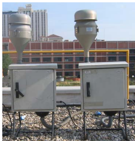
Figura 2.7. Captadores de alto volumen MCV con cabezales de corte DIGITEL para el muestreo de PM 10 y PM 2.5 .
