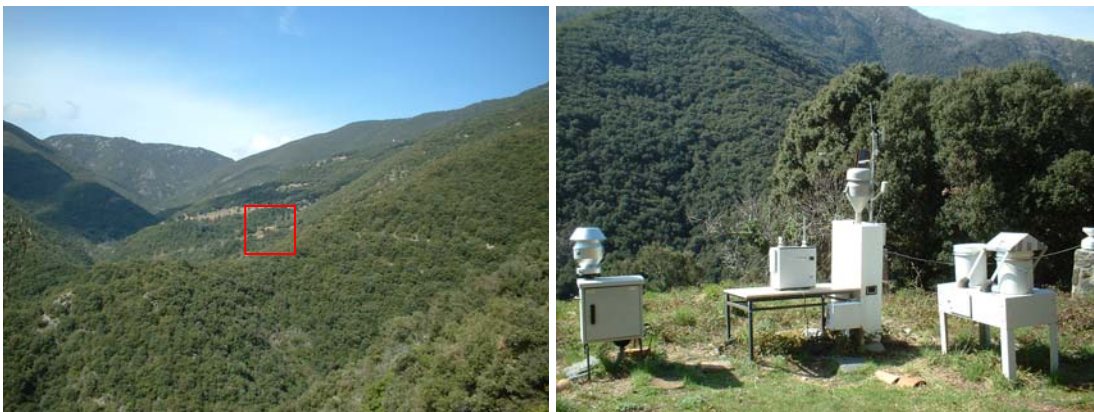
Figura 2.2. Localización de la estación de Montseny. Izquierda: vista general del Valle de La Castanya, y ubicación de la estación de muestreo (recuadro de color rojo); derecha: detalle de la instrumentación instalada en la estación durante el periodo de estudio.
