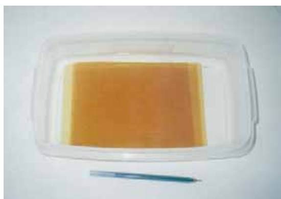
Figura 3.5: Foto de una membrana antes de ser instalada en la celda de ED
