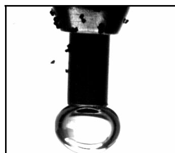
Figura 4.4: Xeringa i agulla utilitzades per crear la bombolla estacionària, i un exemple de la bombolla obtinguda.
