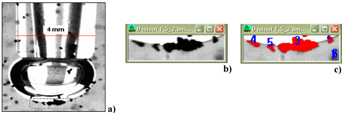
Figura 4.14: a) Fotografia completa d’una bombolla amb tinta. b) Secció de la fotografia anterior on es desitja fer l’anàlisi d’imatges. c) Fotografia b) un cop s’ha aplicat el llindar.
