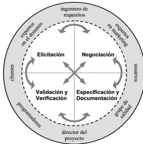
Figura c2_16: Modelo de Proceso de la Ingeniería de Requisitos propuesto por POHL
