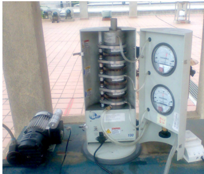
Figura 44: Vista general del impactador y bomba de aspiración de aire
