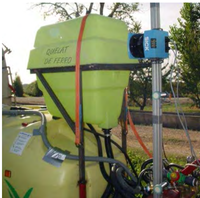
Figura 8.5.- Imatge del dipòsit auxiliar implementat al prototipus Fluxpro 2 per a reduir els temps morts entre assajos.
