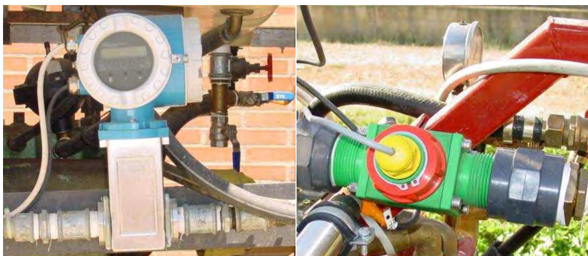
Figura 7.7.- Detall del muntatge del cabalímetre electromagnètic al prototipus Fluxpro 1 (esquerra) i del cabalímetre de turbina muntat al prototipus Fluxpro 2.
