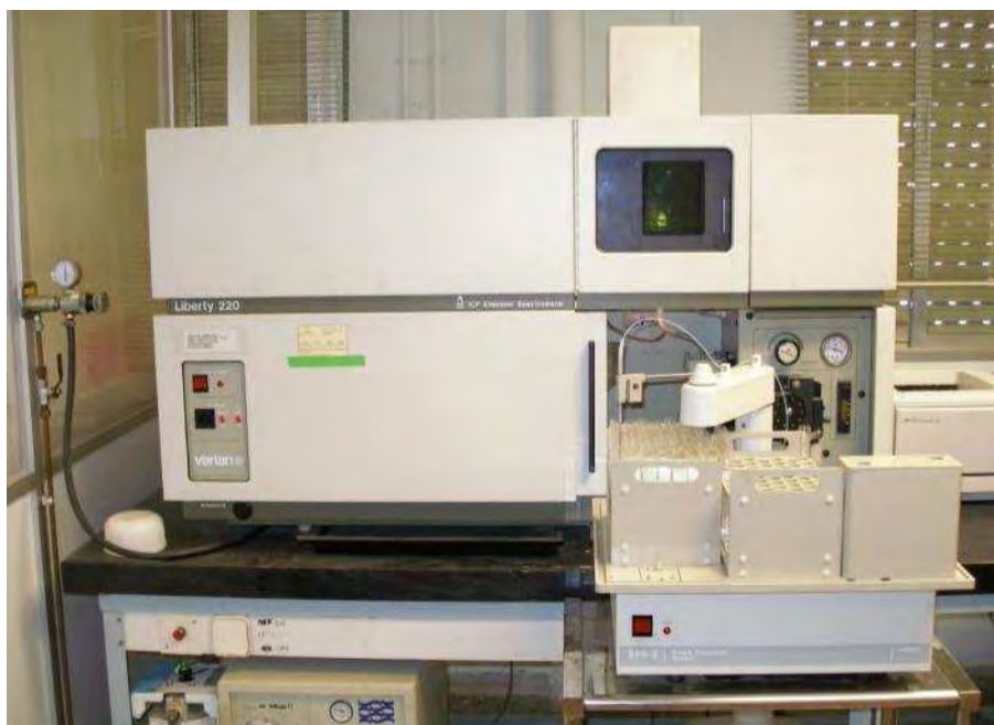
Figura 8.2.- Equip ICP-EOS utilitzat en les anàlisis de les mostres dels assajos, situat al Laboratori Agroalimentari del Departament d'Agricultura, Alimentació i Acció Rural de la Generalitat de Catalunya, situat a Cabriels.
