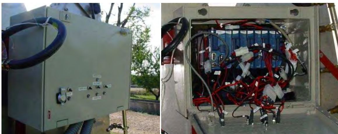
Figura 7.12.- Caixa estanca instal·lada al prototipus Fluxpro 2 per a allotjar el sistema electrònic de regulació. A la tapa frontal es pot veure la interfície d'interacció amb l'usuari constituïda per interruptors i llums indicatius (esquerra). Dins de la caixa hi ha el dispositiu PAC i les connexions elèctriques necessàries (dreta).
