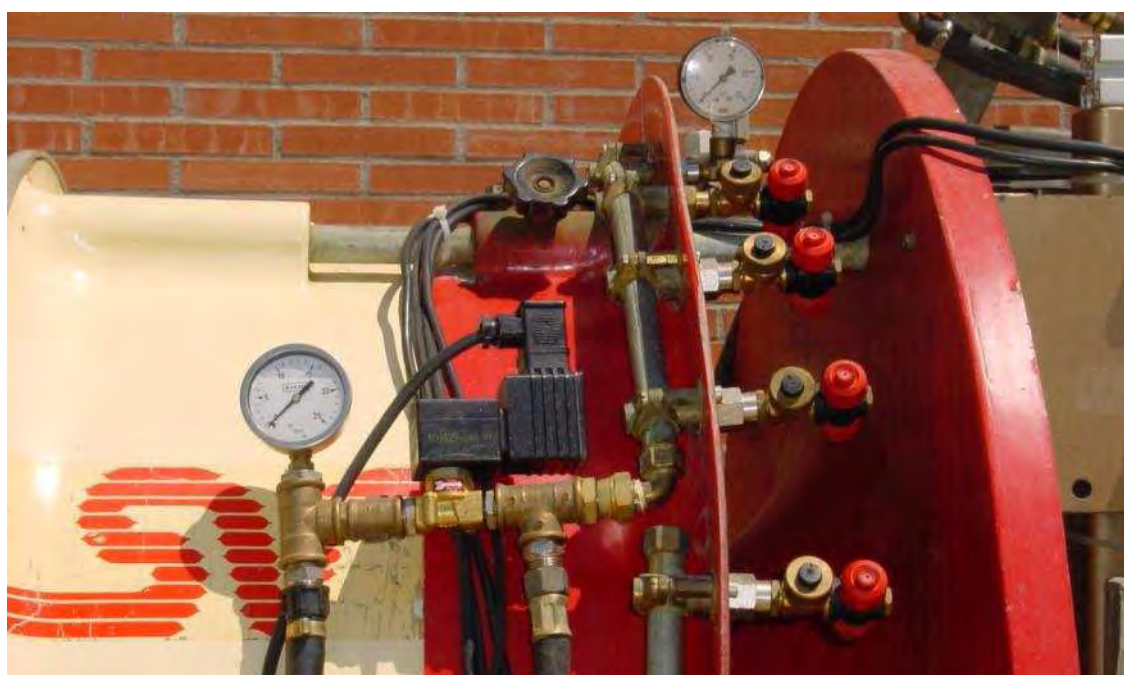
Figura 7.4.- Detall del seccionament de l'arc de polvorització i del muntatge de l'electrovàlvula al prototipus Fluxpro 1.
