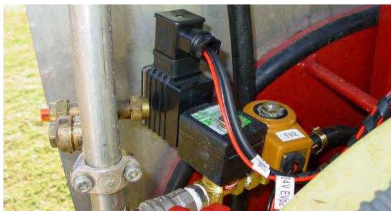
Figura 7.6.- Detall del muntatge de l'electrovàlvula de tall (marró) just abans de l'electrovàlvula proporcional (negra) a l'entrada d'una de les seccions independents de l'arc de polvorització modificat.
