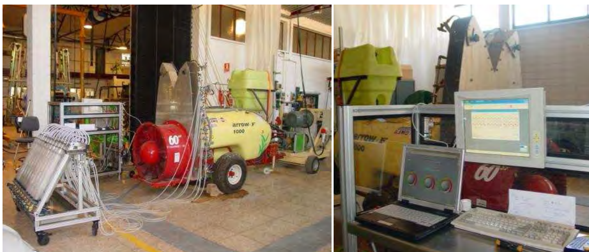
Figura 7.19.- Assaig de comprovació del cabal emès per cadascun dels broquets de les tres seccions independents del prototipus Fluxpro 2 realitzat amb un banc d'assaig de provetes automatitzat.
