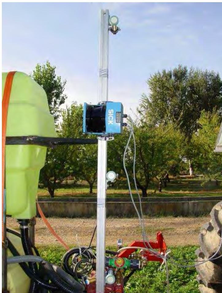
Figura 6.35.- Detall del muntatge per a la caracterització de la capçada amb els tres sensors ultrasònics i el sensor lidar en un polvoritzador hidropneumàtic arrossegat amb el que es va realitzar l'assai de caracterització de la capçada l'any 2006.
