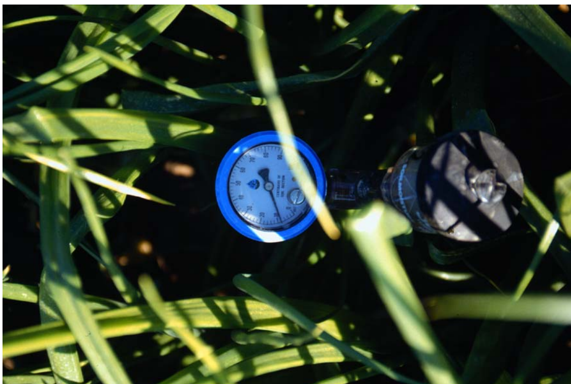
Fotografía 2.1. Detalle de uno de los tensiómetros instalados en las parcelas del ensayo.
