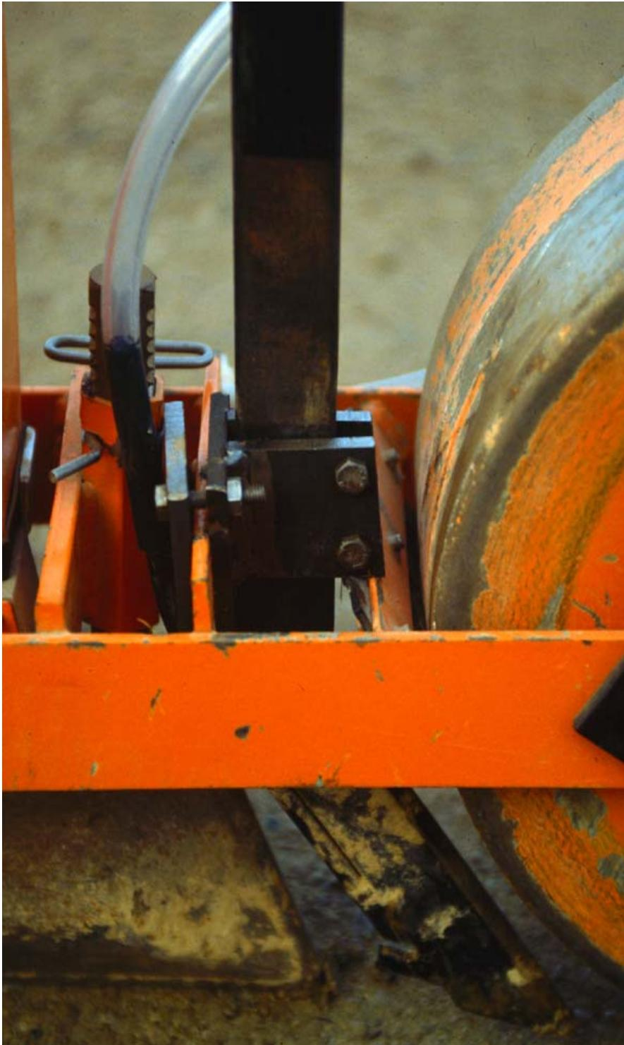
**Fotografía 5.3. Detalle de la reja inyectora.**
